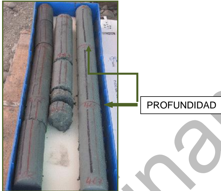
Figura 2. Marcado de profundidades cada pie
