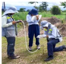
Registro de mediciones de concentración de gases en suelos
