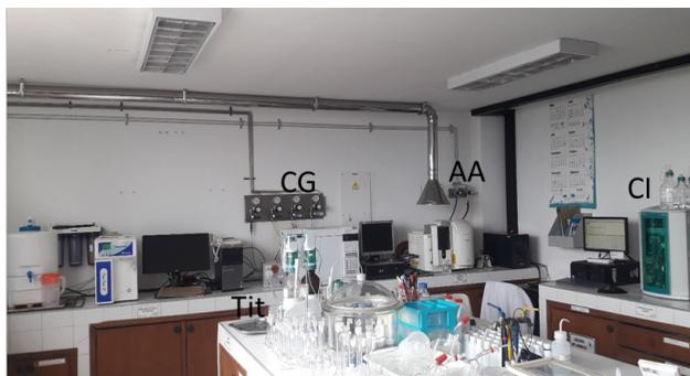
Laboratorio Actual: Equipos de Cromatografía Iónica (CI), Cromatografía Gaseosa (CG), Absorción Atómica (AA) y Titulador automático (Tit)
