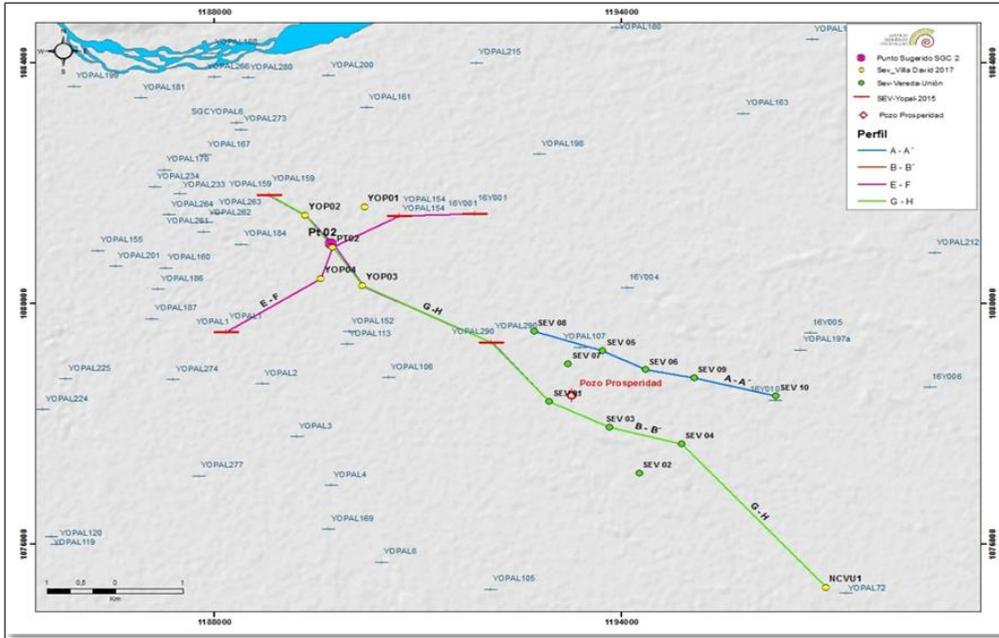
Figura 31. Sondeos y perfiles geoelectricos en el área de influencia donde se perforará el pozo SGC Yopal
