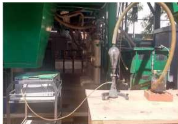
Figura 41. Pretratamiento oxidativo con ozono en sistema Pachuca de material refractario M7944 colas de bates, mina el apique.
