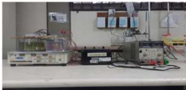
Figura 1. Celda electrolítica para la deposición de oro y cobre.
