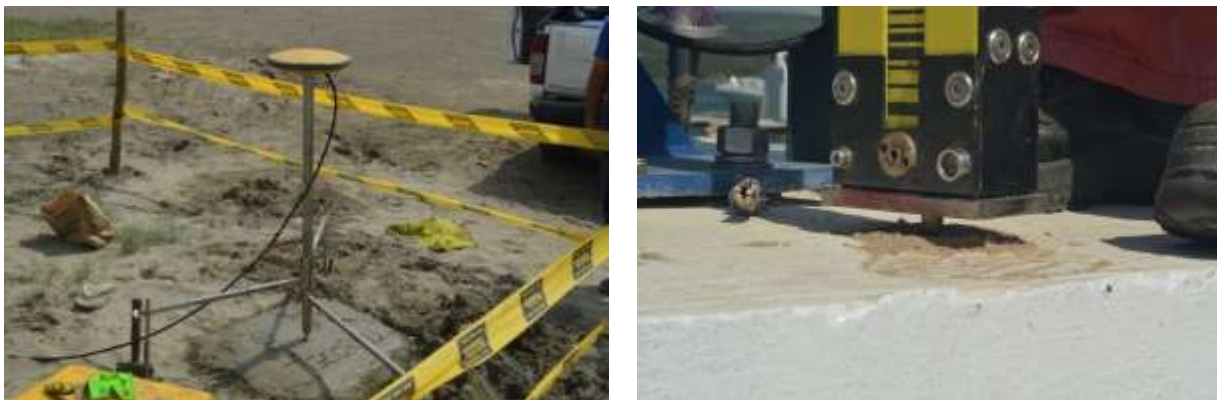
Figura 99. Punto de referencia en estación de campo GNSS para toma de datos GNSS y de nivelación geodésica
