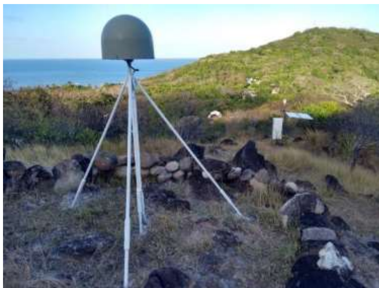
Figura 120. Mantenimiento de la infraestructura de la base de la antena geodésica de la estación GNSS de Isla Providencia.
