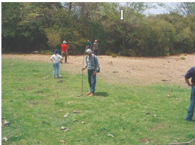
**Figura 28.** Marcación con estacas de la línea de referencia para hacer el descapote de vegetación del lago de falla indicado con la flecha.
