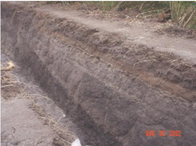
**Figura 34.** Pared este de la trinchera Los Gomos. Se observa que, después del raspado y el lavado, resaltan los niveles estratigráficos y las diferentes estructuras del lago de falla. Sin este trabajo, sería imposible el levantamiento paleosismológico de las paredes de la trinchera.
