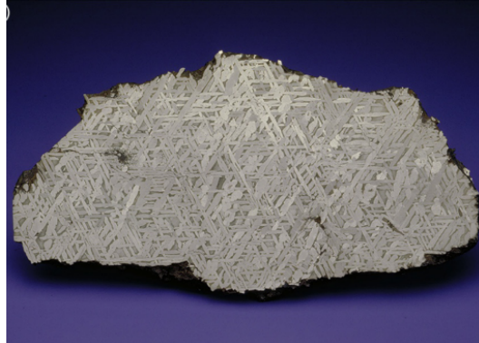
Figura 12. Textura Widmanstätten en un meteorito metálico
