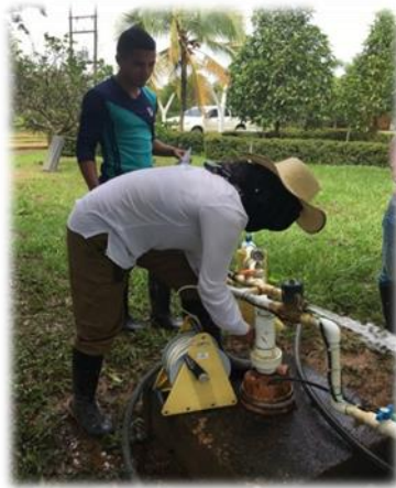
Medición de niveles y caudales en pozos de 2 a 6 pulgadas, revestidos con tuberías pvc y acero.
