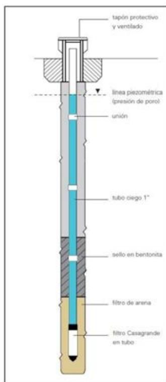
Figura. Esquema del piezómetro tipo Casagrande
