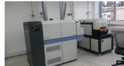
**Imagen 1.** Equipo de espectrometría de masas con plasma inductivamente acoplado con ablación láser.
