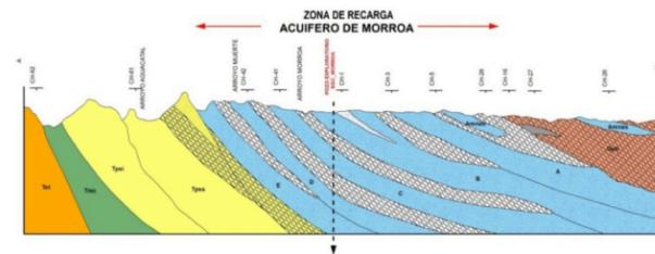
Figura 1. Esquema del modelo hidrogeológico del acuífero de Morroa para el sector donde se perfora el pozo SGC-Morroa 1.
