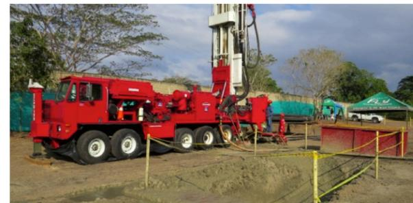
Figura 2. Equipo de perforación exploratoria Srammer 2000, utilizado para la perforación del pozo exploratorio SGC-Morroa 1. Profundidad alcanzada a la fecha: 300 metros. Contrato 360 de 2014, Llanopozos-SGC.
