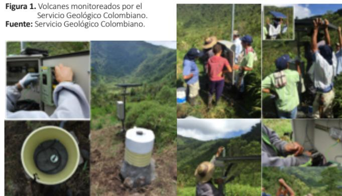
Figura 3. Instalación de la primera estación sismológica en el volcán El Escondido (Florencia-Caldas).
