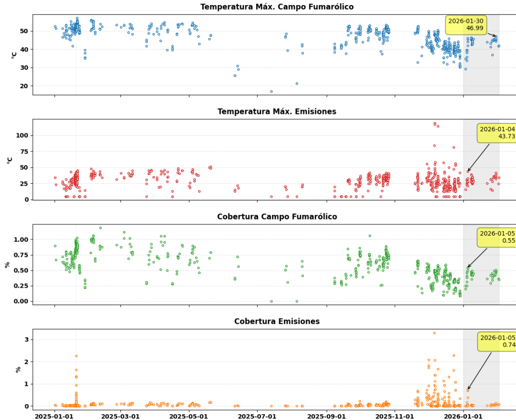
Figura 22. Registro del monitoreo térmico infrarrojo con la cámara Mina2IR a 2,2 km al noroeste del cráter del volcán Puracé. a) Temperatura máxima aparente medida en el campo fumarólico (emisividad \epsilon=0.9 ). b) Temperatura máxima aparente medida en la nube de gases (emisividad \epsilon=0.6 ) o gases y ceniza (emisividad \epsilon=0.9 ). c) Porcentaje de píxeles sobre el campo fumarólico con temperaturas aparentes superiores a 20°C (emisividad \epsilon=0.9 ). d) Porcentaje de píxeles con temperaturas aparentes superiores a 10°C (emisividad \epsilon=0.6 ) durante las emisiones de gases y/o cenizas
