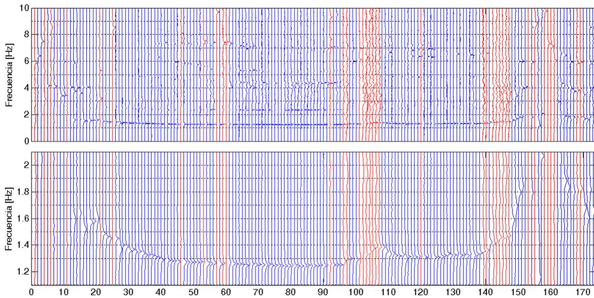
**Figura 2.12.** La figura superior muestra el comportamiento de la frecuencia dominante y subdominante de eventos tipo Tornillo (azul) y Seudo-Tornillo (rojo); nótese la tendencia descendente en ellas. En la figura inferior se muestra un detalle de frecuencias entre 1,1 y 2,1 Hz. Noviembre de 2006 a junio de 2007. Estación sísmica Anganoy.
