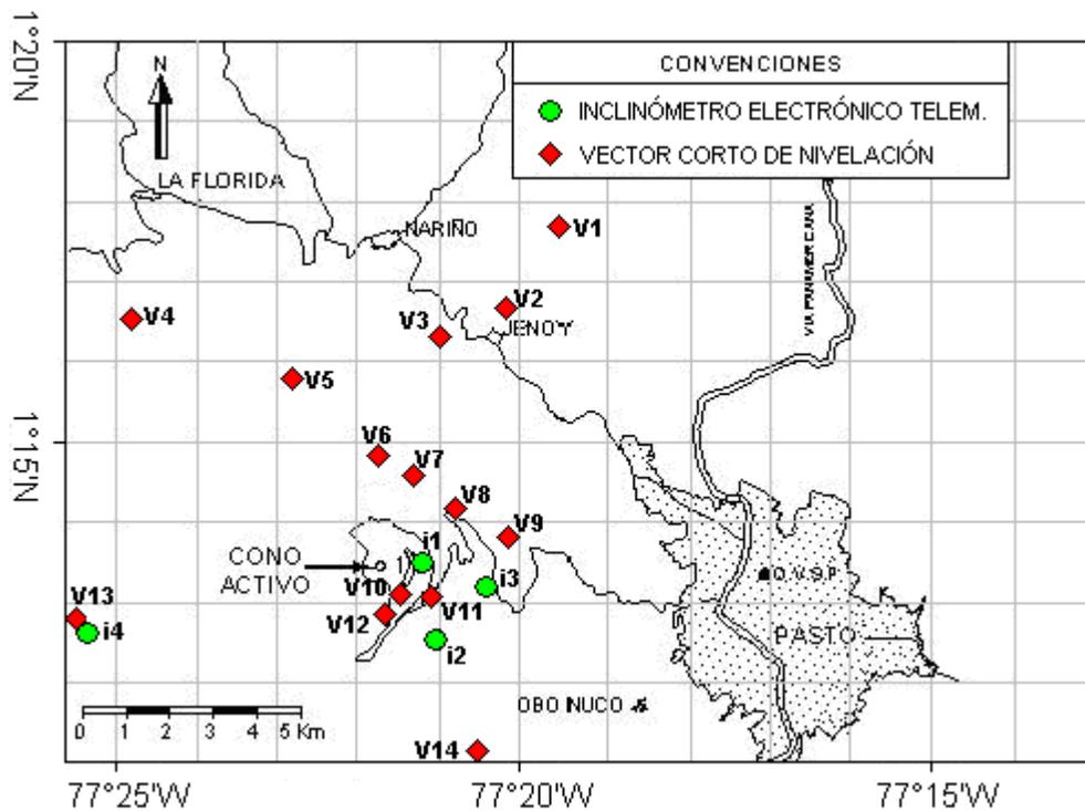
**Figura 2.19.** Red de vigilancia en Deformación del Volcán Galeras. Inclinómetros electrónicos: i1: Cráter, i2: Peladitos, i3: Urcunina, i4: Calabozo. Vectores cortos de nivelación: V1: Puyito, V2: Lindero, V3: Chorrillo, V4: Chacaguaico, V5: Barranco, V6: Chiguaco, V7: Popeye, V8: Piedras, V9: La Mica, V10: La Y, V11: Inclinómetro, V12: Telecom, V13: La Quebrada, V14: Cobanegra.
