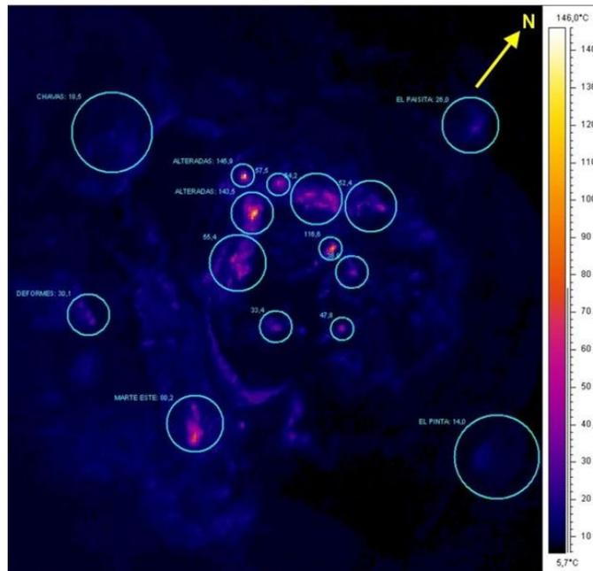
**Figura 2.40.** Imagen térmica tomada durante el sobrevuelo efectuado el 22 de enero de 2007. Las temperaturas máximas se registran principalmente hacia el sector WNW de la pared interna del cráter principal (Alteradas), alcanzando valores cercanos a los 150 °C.
