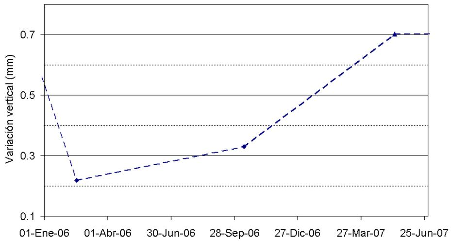
**Figura 2.25.** Comportamiento del vector corto de nivelación Telecom.
