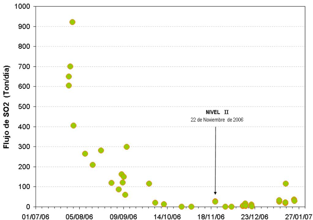
**Figura 2.33** Emisiones de SO<sub>2</sub>, medidas con Mini-DOAS y Scan-DOAS (NOVAC). Segundo semestre de 2006 y primer semestre de 2007.
