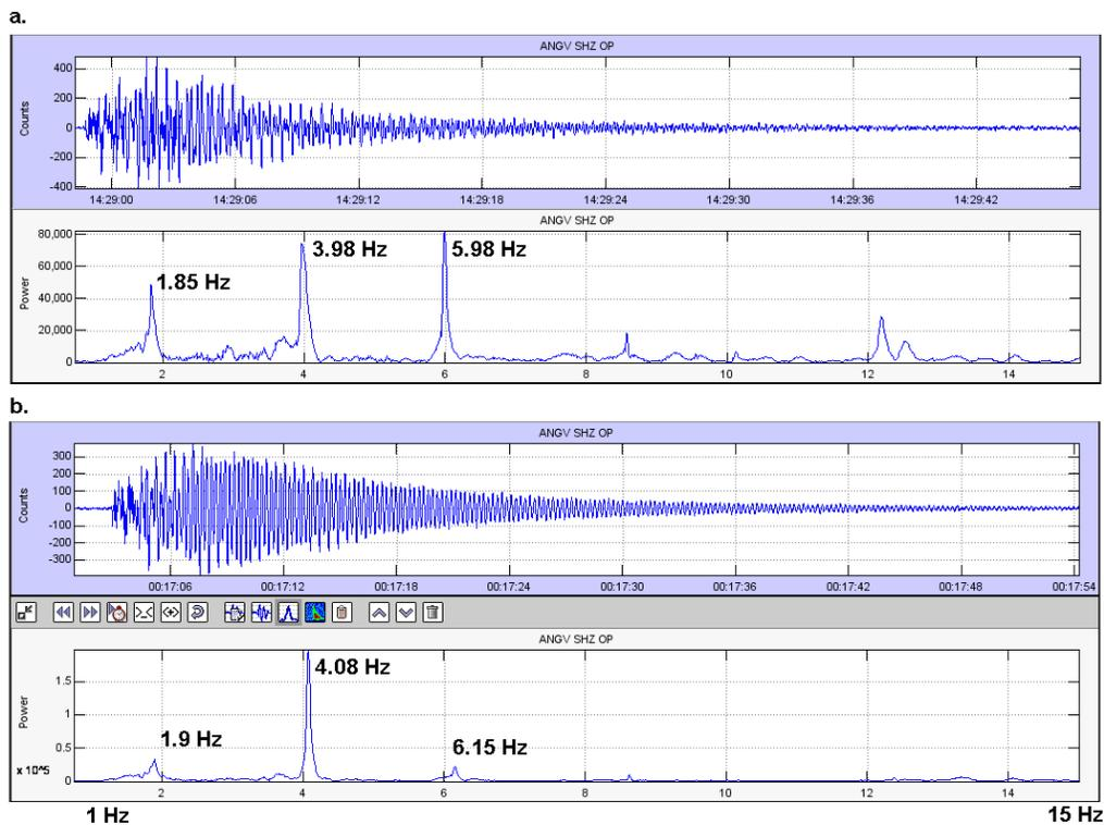
**Figura 13.** a) Forma de onda (50 segundos) y espectro para el evento tipo TOR de abril 3 a las 9:29 a.m. b) Forma de onda (60 segundos) y espectro para el evento tipo TOR de abril 8 a las 7:17 p.m.
