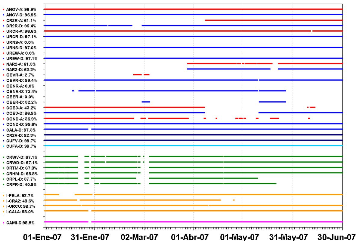
**Figura 2.2.** Histograma de funcionamiento y respectivos porcentajes de operación de las estaciones de CP, estaciones de BA (CR2V, CUFV, CUFA), estación climática (CRWV, CRWD, CRTM, CRHM, CRPL, CRPR), inclinómetros electrónicos (I-PELA, I-CRA2, I-URCU, I-CALA) y el micrófono (CAMI), para vigilancia de Galeras. Enero a Junio de 2007.
