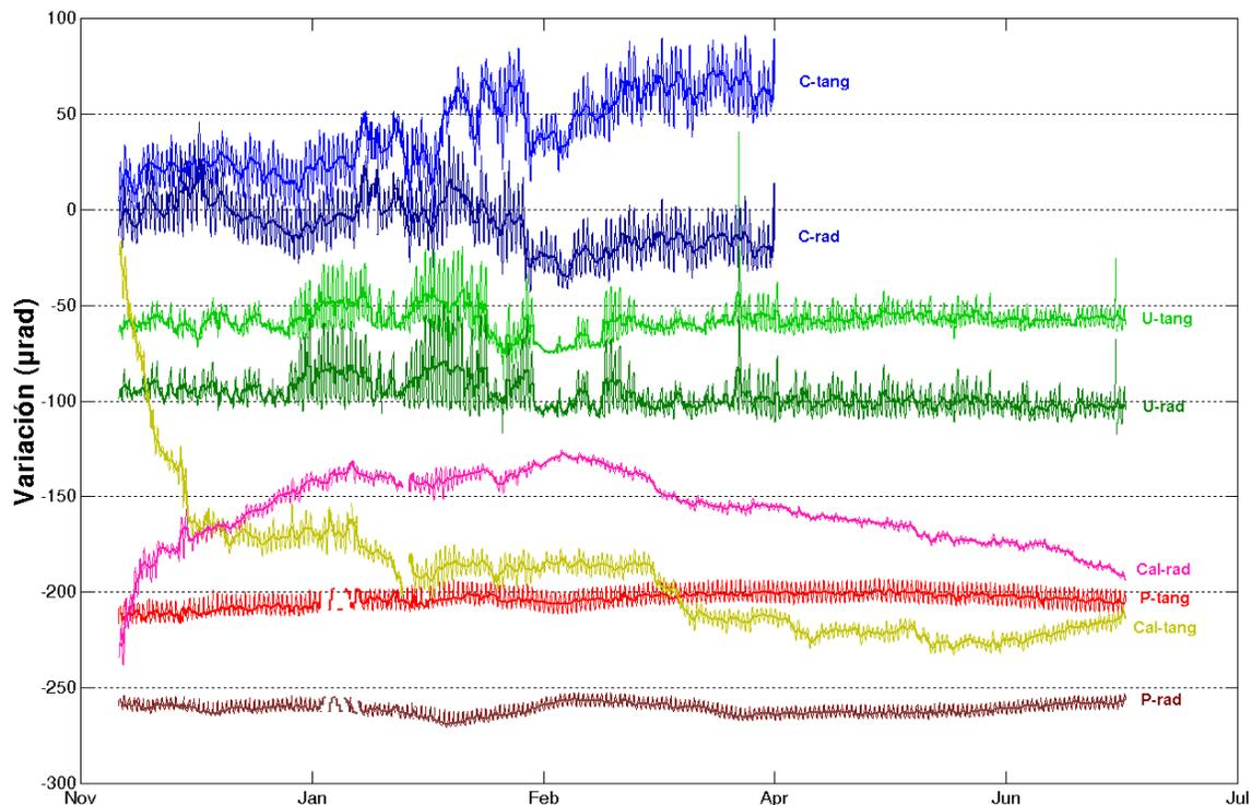
**Figura 2.32.** Comportamiento de las componentes de inclinación tangencial y radial de los inclinómetros electrónicos telemétricos, para el período comprendido entre el 27 de noviembre de 2006 y el 31 de junio de 2007. En general las fluctuaciones diarias se deben a los ciclos día-noche. **C:** Cráter, **U:** Urcunina, **Cal:** Calabozo y **P:** Peladitos.
