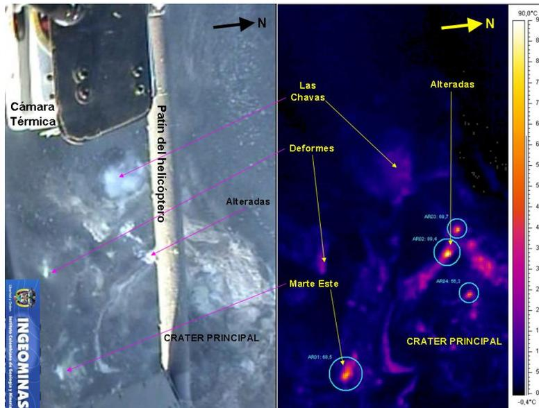
**Figura 2.41.** Imagen térmica tomada durante el sobrevuelo efectuado el 29 de enero de 2007. Se realiza una comparación entre una fotografía normal (izquierda) y una imagen térmica (derecha) del cono activo, tomadas a una altitud aproximada de 430 m sobre la cima. Los círculos resaltan las zonas con las más altas temperaturas registradas.
