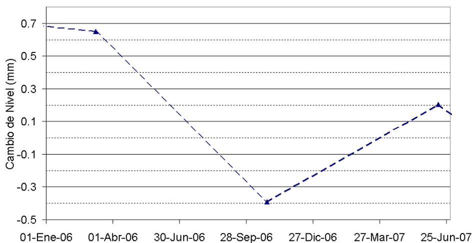
**Figura 2.24.** Comportamiento del vector corto de nivelación Chacaguaico.
