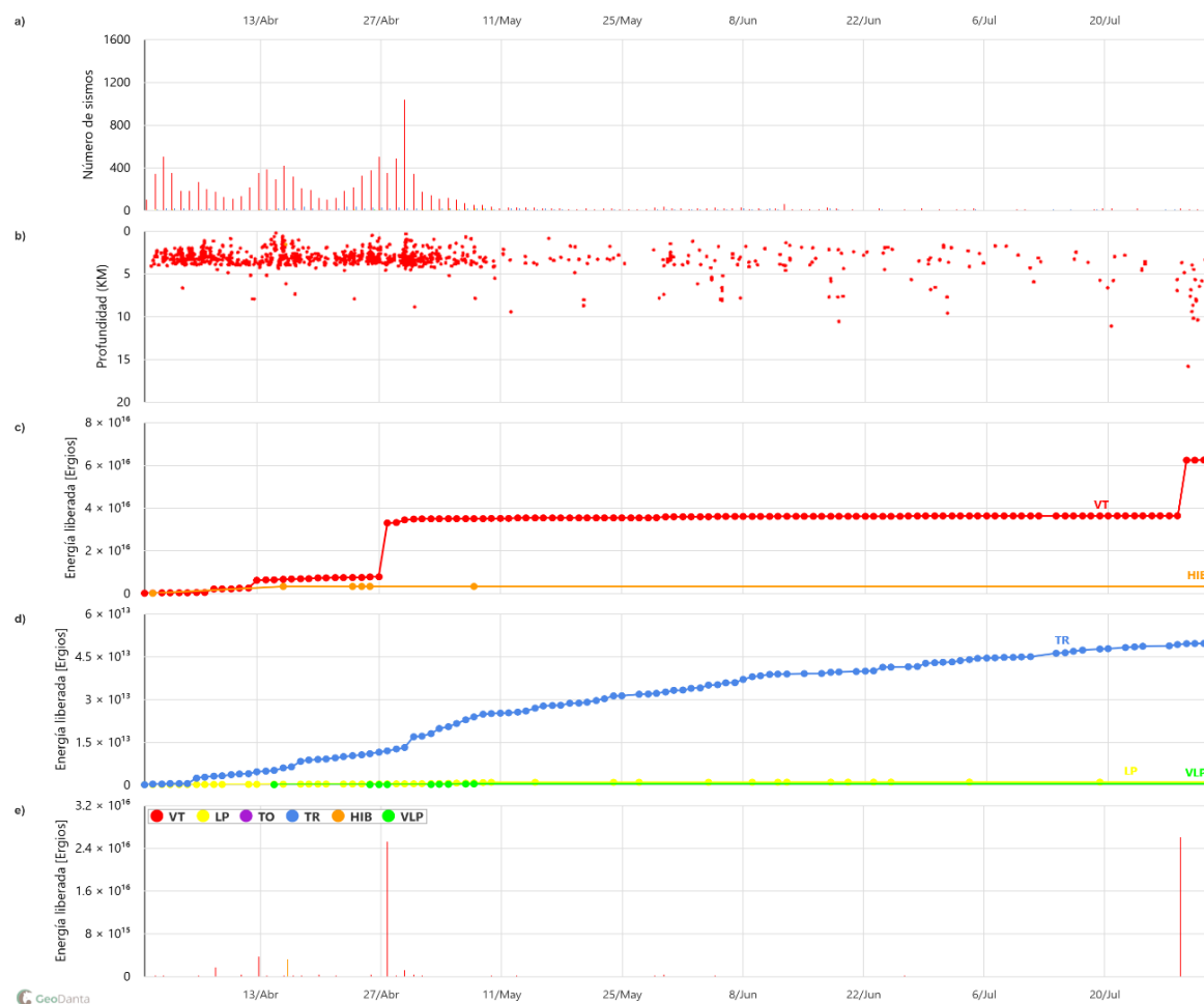
Figura 5. Gráfica multiparamétrica del CVCCN para el periodo entre abril y julio de 2026, a) histograma diario de ocurrencia sísmica b) evolución temporal de la profundidad de los sismos tipo VT c) energía acumulada para sismos tipo VT e HIB. d) energía acumulada para sismos tipo TR, LP y VLP e) energía diaria liberada para sismos, VT, LP, TR, HIB y VLP.
