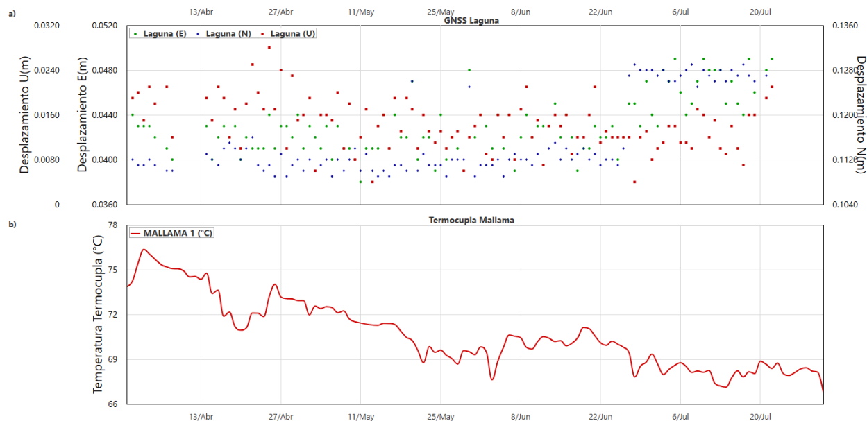
Figura 9. a) series temporales del cGNSS Laguna componentes Norte (azul), Este (verde) y Vertical (rojo), y b) temperatura del campo fumarólico en el Domo Mallama. Para el periodo entre abril y julio de 2026.
