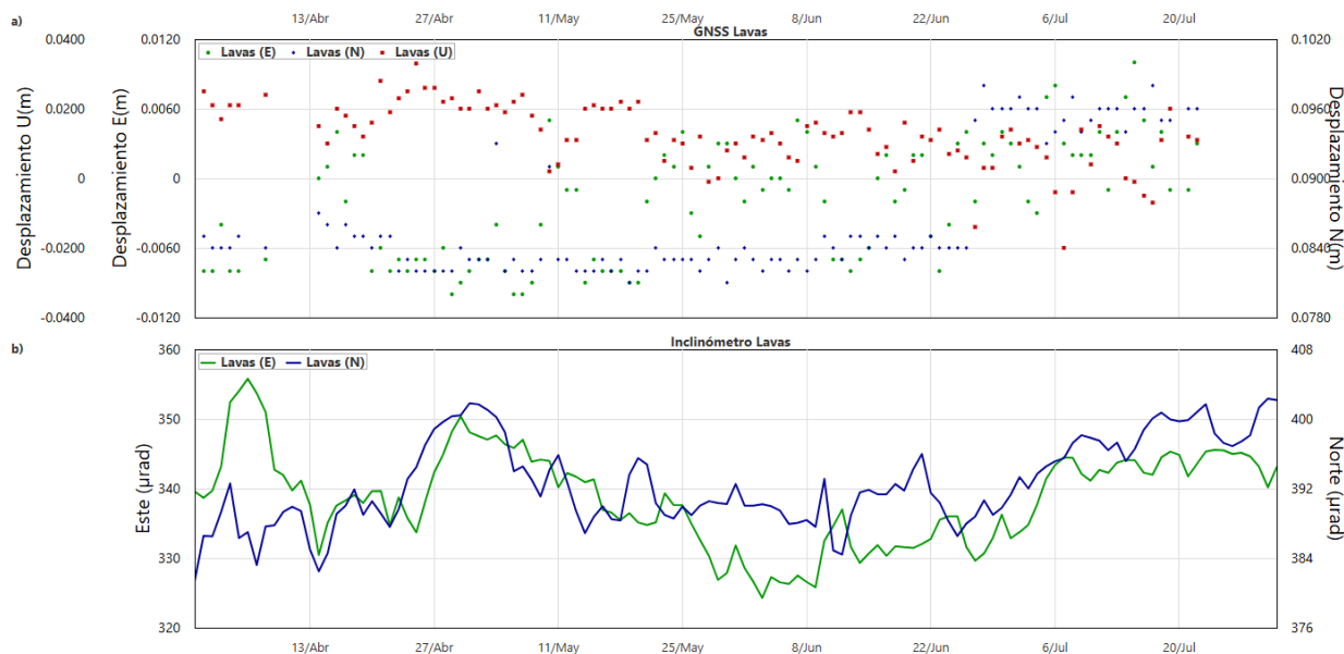
Figura 12. a) componentes Norte (azul), Este (verde) y Vertical (rojo) del cGNSS Lavas, b) Series con evolución en el tiempo del Inclinómetro electrónico Lavas, componentes Norte (azul) y Este (verde) ubicados en la zona de los volcanes Las Ánimas – Doña Juana, en el periodo entre abril y julio de 2026.
