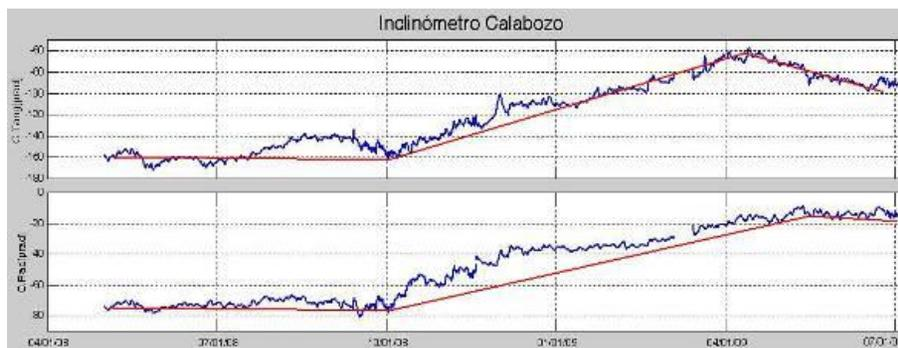
**Figura 2.1.71.** Comportamiento de la componente tangencial y radial del inclinómetro Calabozo.
