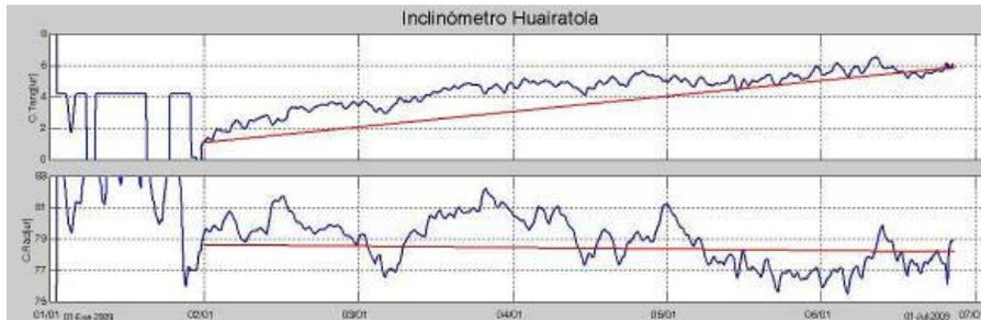
**Figura 2.1.72.** Comportamiento de la componente tangencial y radial del inclinómetro Huairatola.
