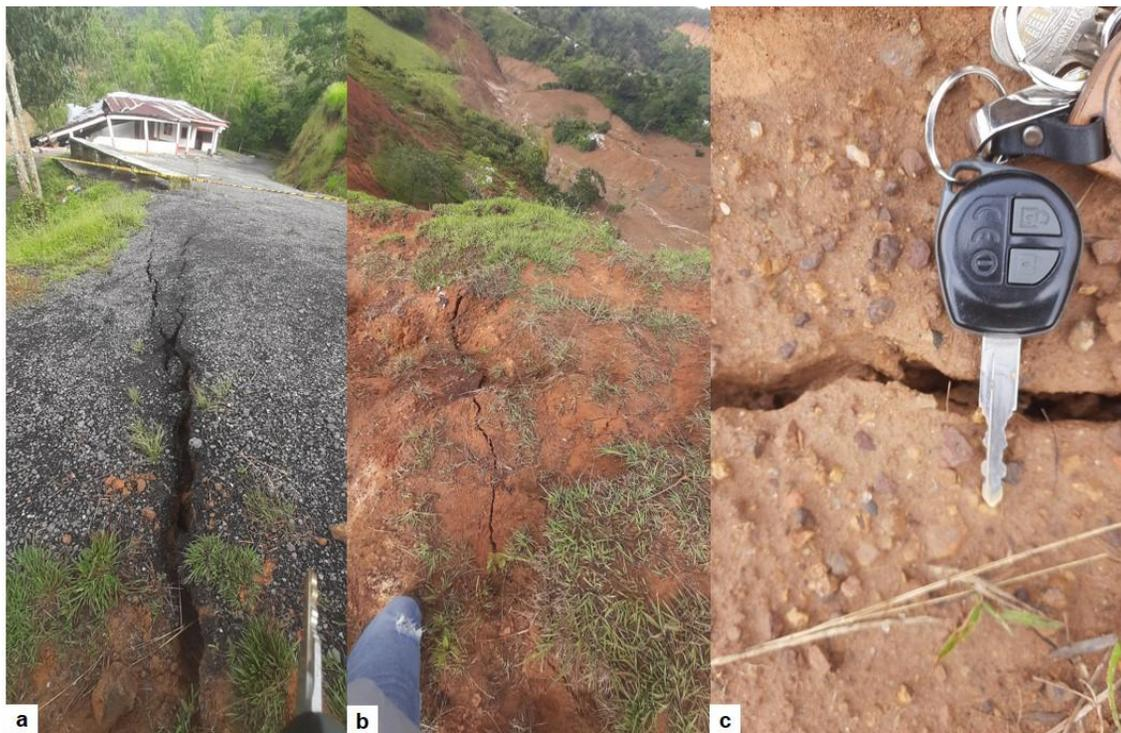
**Figura 34.** Grietas de tensión y escarpes observados en el flanco izquierdo, sector La Gallera, vereda La Soledad
