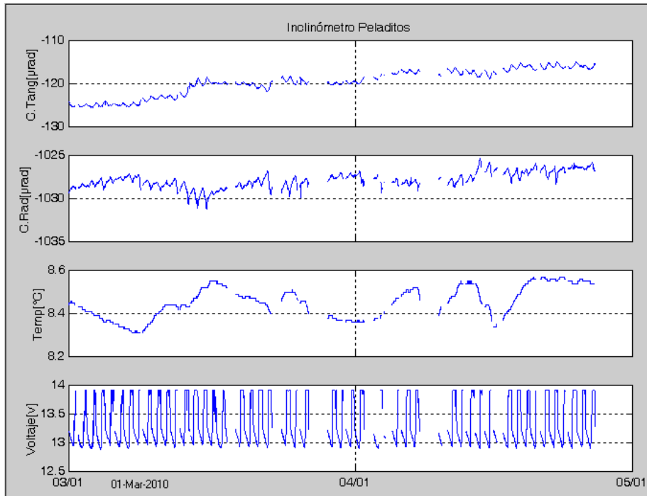
Figura 10. Componentes de inclinación radial y tangencial del inclinómetro Peladitos, para el periodo comprendido entre el 1 de marzo y el 26 de abril de 2010.
