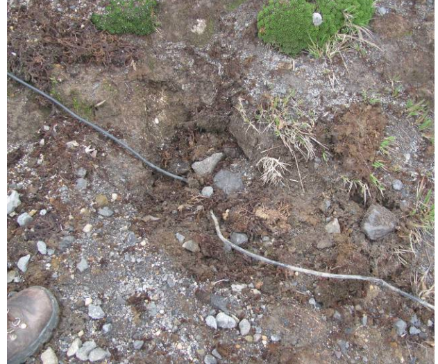
Figura 25. Daño de paneles solares (izquierda). Impacto de roca sobre el cable de la antena de la estación de Anganoy (derecha).
