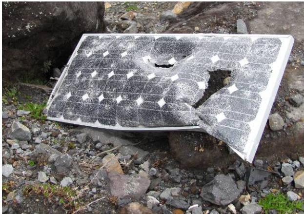
Figura 26. Daño de panel solar (izquierda). Daño en la antena de transmisión de datos del inclinómetro electrónico Cráter (derecha).
