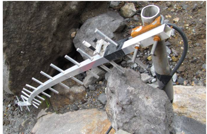
Figura 26. Daño de panel solar (izquierda). Daño en la antena de transmisión de datos del inclinómetro electrónico Cráter (derecha).
