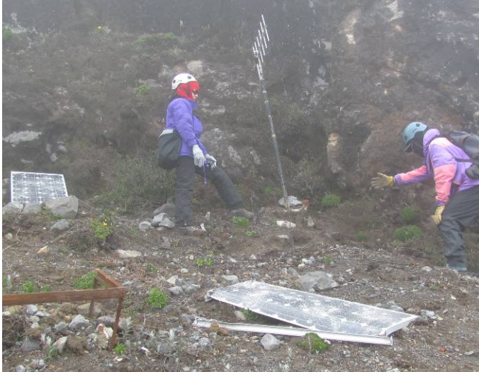
Figura 25. Daño de paneles solares (izquierda). Impacto de roca sobre el cable de la antena de la estación de Anganoy (derecha).
