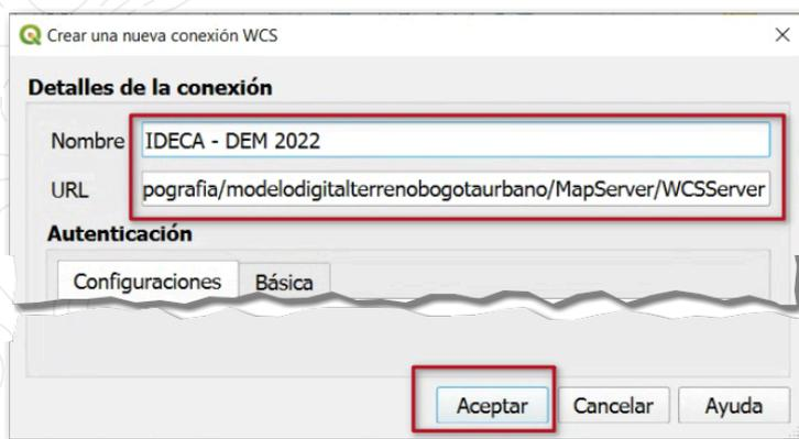
Imagen 16. Configuración de conexión a un servicio WCS de IDECA
