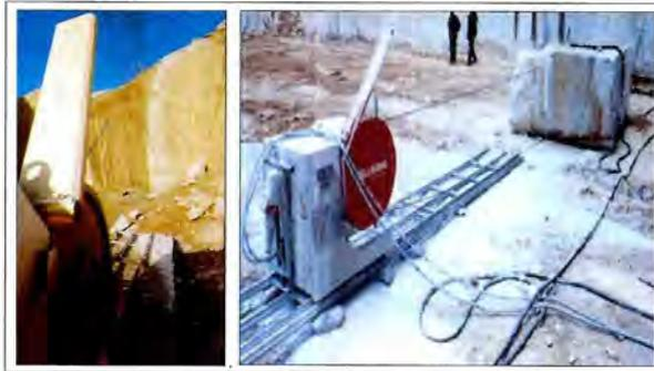
Foto 4. Sistema de explotación para mármol con sistema de hilo helicoidal.
