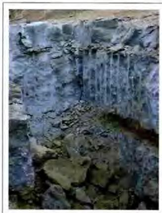
Foto 5. Sistema de explotación por perforación y material expansivo (Curití, Santander).
