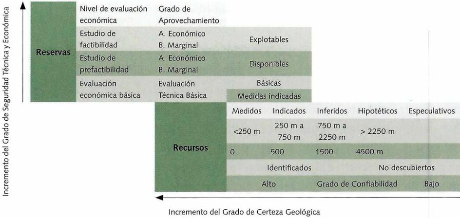
Figura 2. Sistema de clasificación de recursos y reservas de carbón. Tomado y reformado de Wood et ál., 2003.
