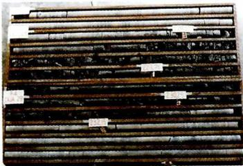
Figura 1. Núcleos de perforación exploratoria.
