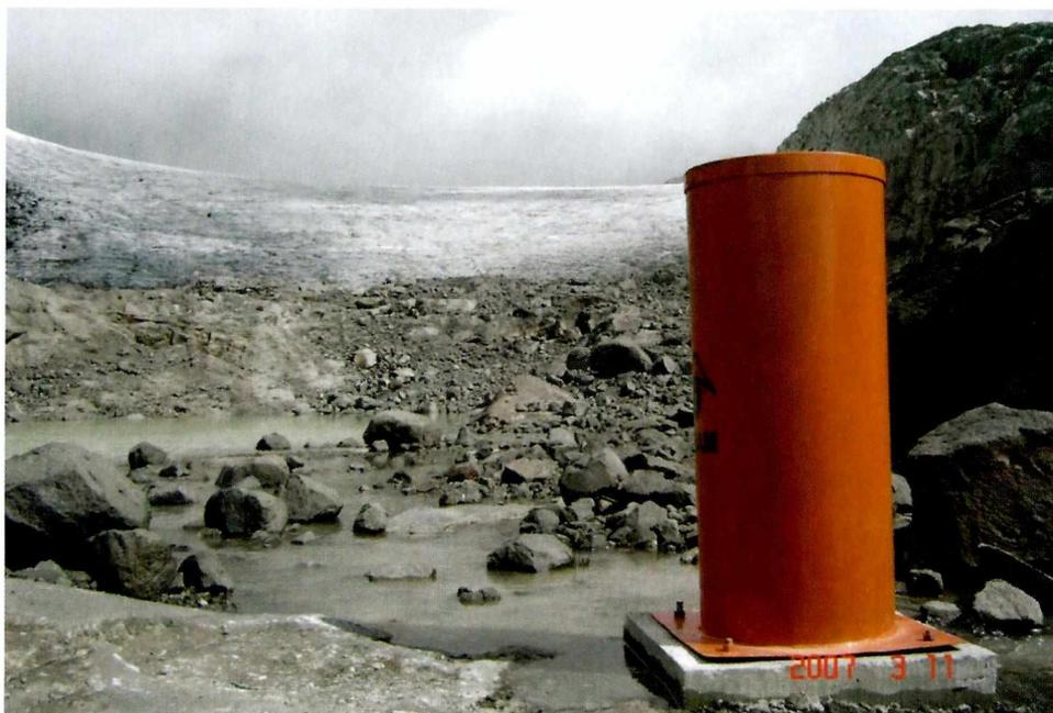
Figura 9. Pluviómetro totalizador cerca del glaciar Conejeras.
