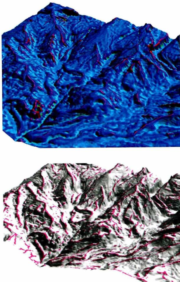
**Figura 4.** Escenas de la parte occidental en el MDT logrado para la Sierra Nevada del Cocuy, después del reconocimiento hecho mediante un nuevo clasificador difuso implementado para Grass, versión 6.3. En la figura de arriba hay una densa gama de colores, mientras que en la de abajo sólo se usa un color para clasificar y representar una amplia serie de estructuras de terreno.
