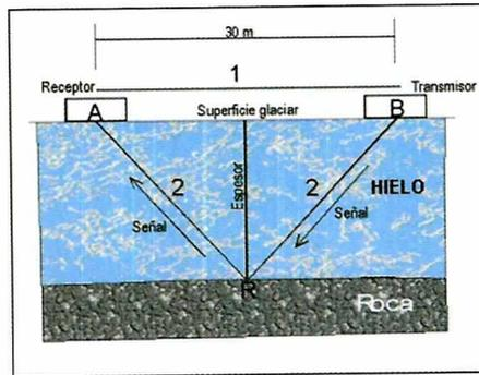
Figura 2. Ilustración del trabajo de campo con el sistema de radar de impulso.
