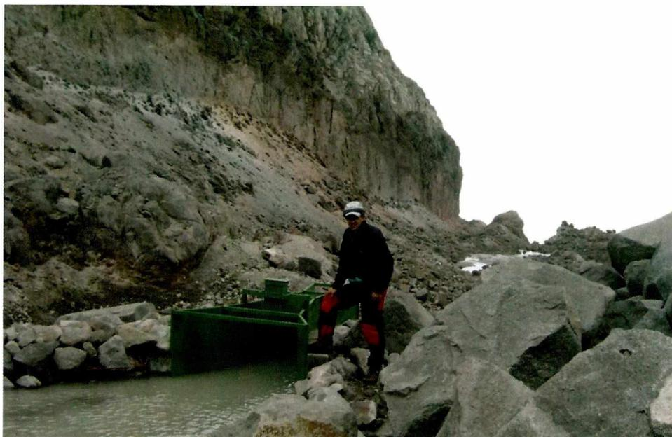
Figura 8. Canaleta tipo Parshall cerca del glaciar Conejeras.
