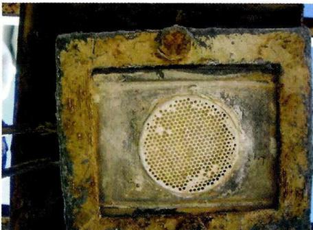
**Figura 7.** Sensor de nivel deteriorado por la corrosión en la estación Molinos (Mejía & Botero, 2008).
