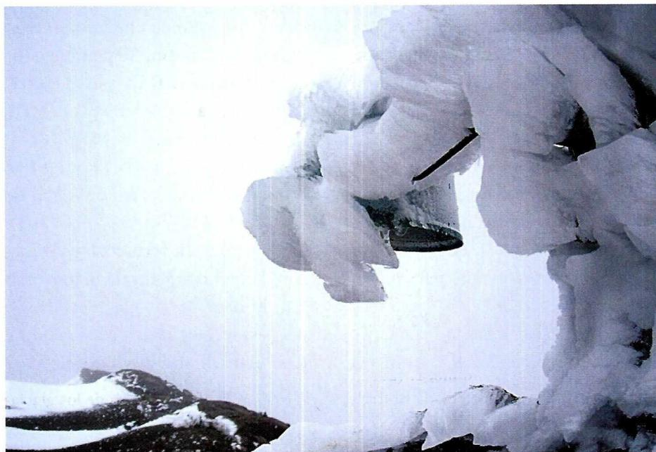
**Figura 9.** Recipiente que contiene el sensor de temperatura, cables y soportes cubiertos totalmente por hielo. Estación Kumanday (Mejía & Botero, 2008).
