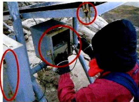
**Figura 8.** Corrosión de los elementos de algunas estaciones en las estructuras de soporte y seguridad para los elementos de medida (Mejía & Botero, 2008).
