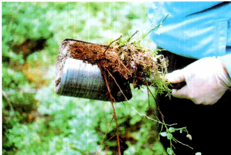
FIGURA A2. Muestreo de humus usando muestreador cilíndrico. Tomado de Foregs (Salminen et ál., 1998).
