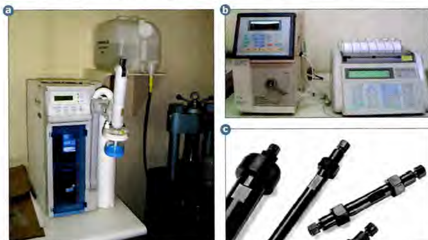
Figura 1.9. a. Purificador de agua Millipore MilliQ JR 8. b. Cromatógrafo iónico TOA IA-100. c. Paquete de columnas iónicas.
