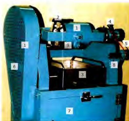
Figura 2.3. Partes que conforman el molino de bolas del laboratorio de metalurgia de Ingeominas, Cali.
