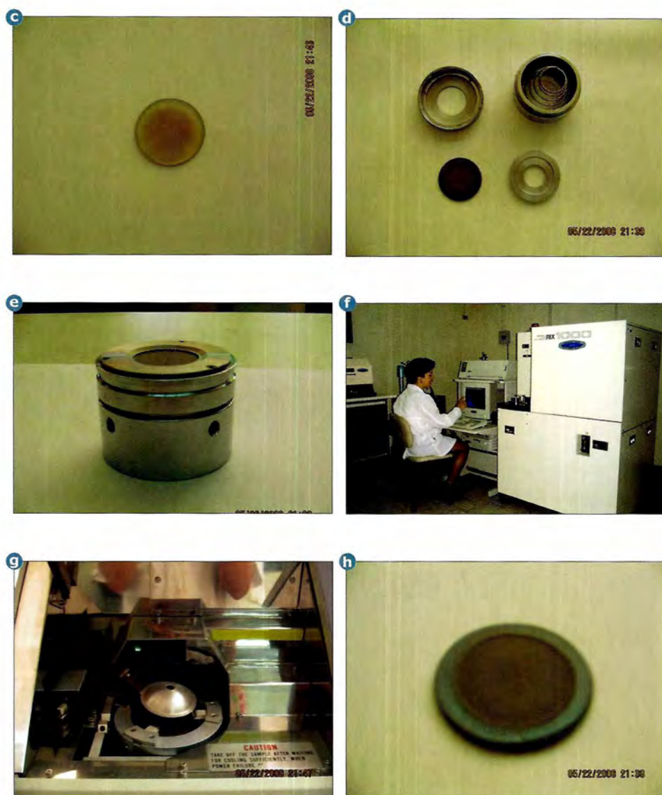
Figura 2.2. c. Pastilla terminada. d. Montaje de la muestra. e. Muestra lista para ser analizada en el equipo FRX. f. Lectura en el equipo FRX y análisis de resultados. g. Horno donde se lleva a cabo la fusión de la pastilla. h. Pastilla fundida transparente.
