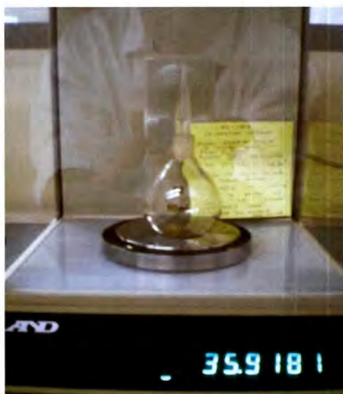
Figura 11.1. Peso del picnómetro vacío.
