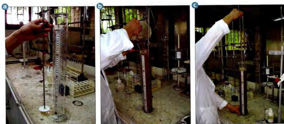
Figura 4.2. a. Posición de la cinta graduada. b. Vertimiento de pulpa en cilindro graduado. c. Agitación de la pulpa.
