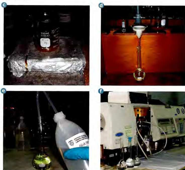
Figura 6.1. a. Pesaje de la muestra en la balanza analítica. b. Adición de HCl, \text{HClO}_4 y \text{HNO}_3 concentrados. c. Calentamiento de la muestra. d. Filtración de la solución. e. Agua desmineralizada. f. Lectura por absorción atómica
