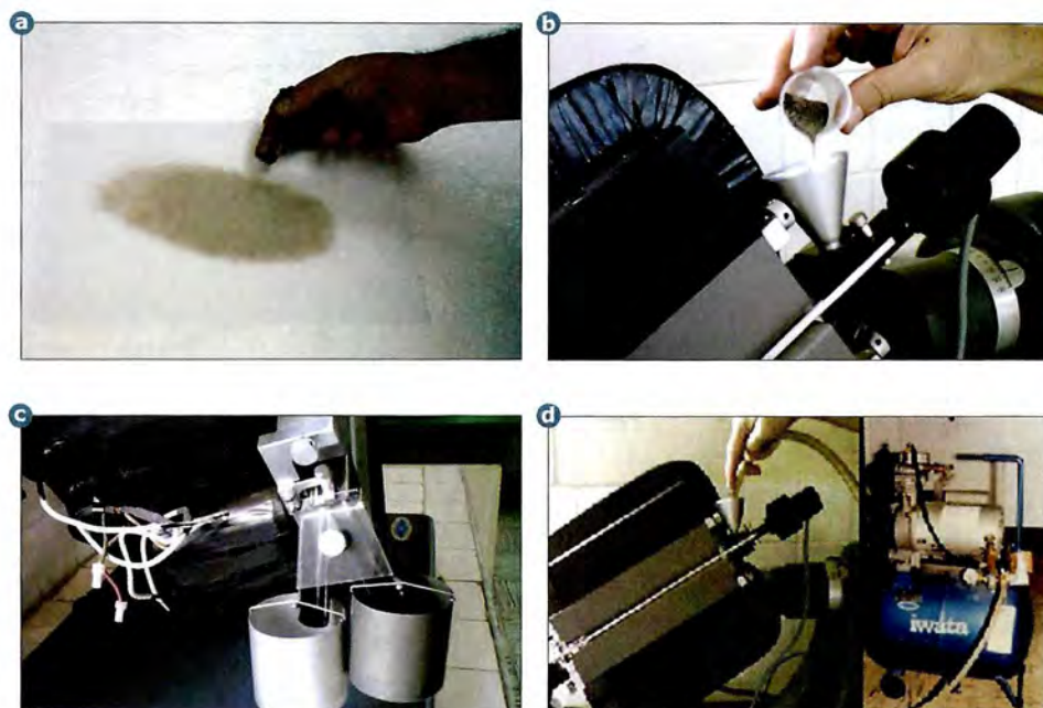
Figura 4.14. a. Extracción manual de minerales altamente magnéticos. b. Alimentación manual de la muestra al separador magnético. c. Obtención de dos fracciones con diferente susceptibilidad magnética. d. Limpieza del equipo mediante aire comprimido.
