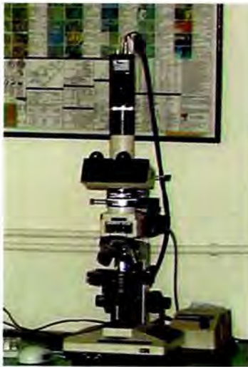
Figura 1. Microscopio petrográfico de luz transmitida y reflejada, con analizador de imágenes acoplado, marca Olympus BH2.
