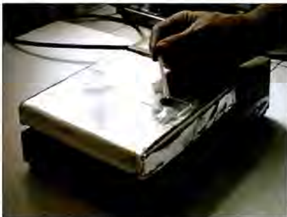
Figura 4.7. Adición de resina epóxica sobre la muestra.
