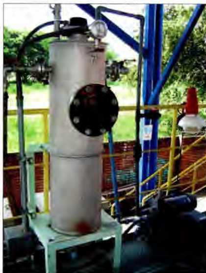
Figura 7.5. Torre desoxigenadora TC-C508.
