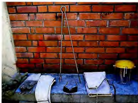
Figura 12.3. Guantes de material refractario, guantes para manejo de soluciones, gafas con filtro ultravioleta, delantal de material refractario y careta.
