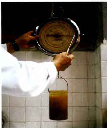
Figura 11.10. Lectura de densidad de pulpa.
