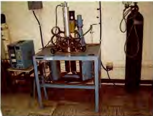
Figura 9.2. Autoclave para oxidación de minerales a alta presión y temperatura.
