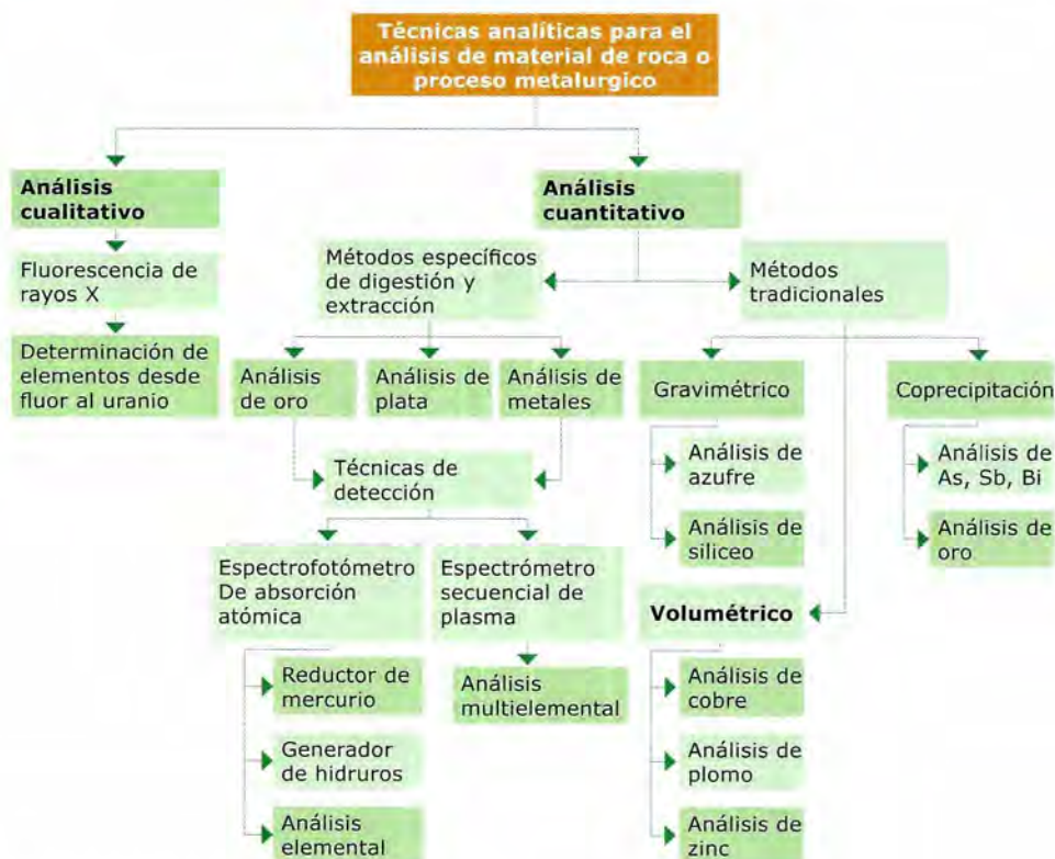
Figura 1.1. Métodos analíticos e instrumentación.
