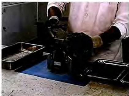
Figura 12.4. Proceso de cuarteo.
