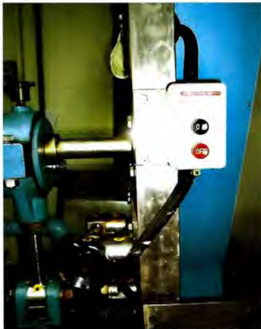
Figura 6.3. Regulador de velocidad de pistón.
