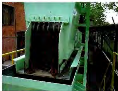
Figura 1.3. a. Tolva de almacenamiento. b. Alimentador vibratorio
