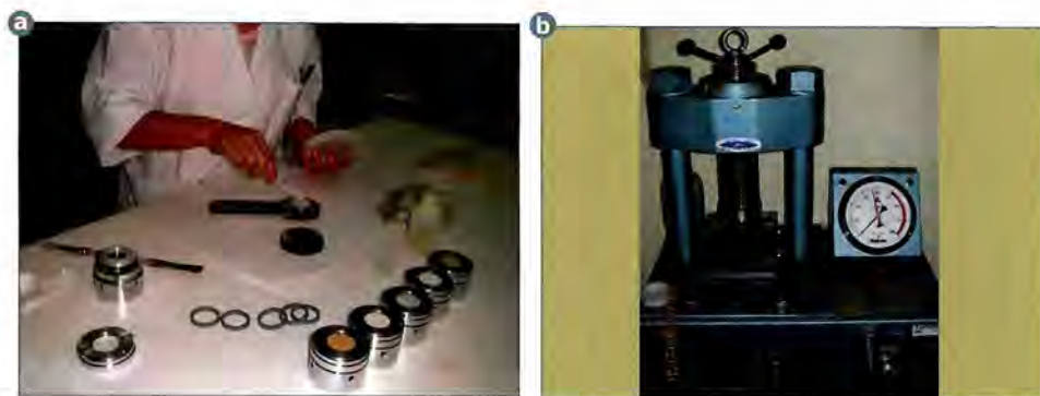
Figura 2.2. a. Montaje de muestra para la elaboración de pastilla en el soporte. b. Equipo prensa-preparación de pastillas.
