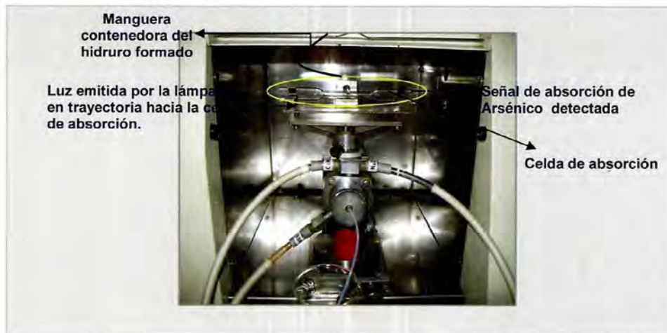
Figura 7.2. Montaje de la celda de absorción en la cabeza del quemador espectrofotómetro de absorción atómica.
