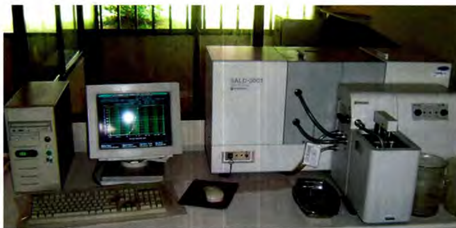
Figura 3.3. Equipo de difracción de rayo láser para la determinación de la distribución de tamaño de partícula.
