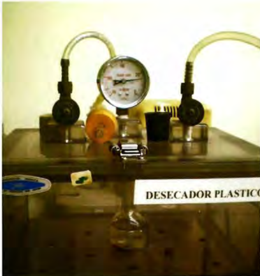
Figura 11.3. Extracción de aire por vacío.
