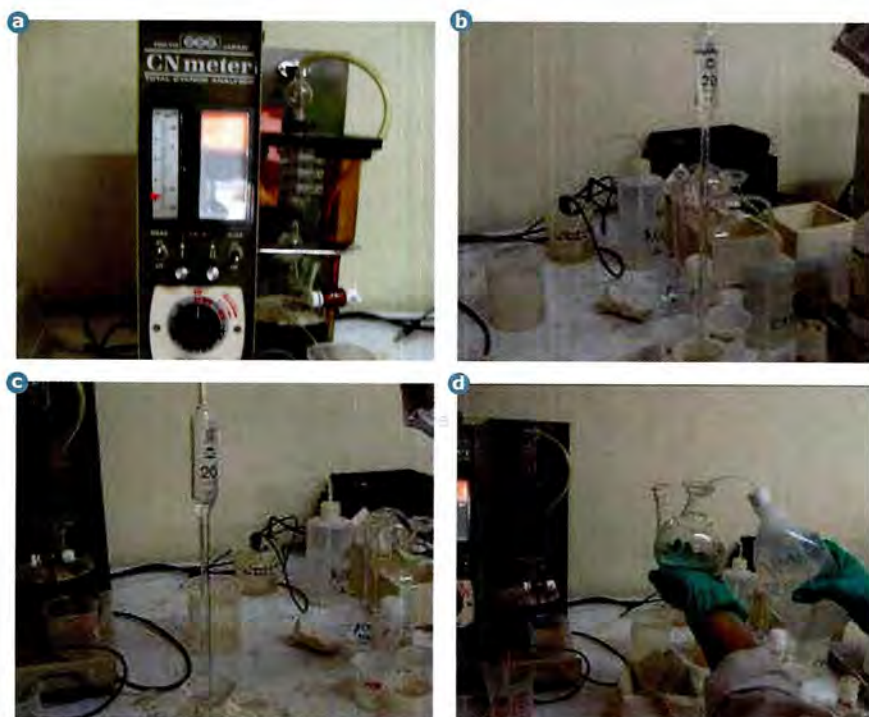
Figura 10.3 . a. Confirmación de lectura del blanco: < 0,05 ppm. b. Toma de 20 mL de muestra. c. Adición al matraz de destilación. d. Adición de agua desionizada.
