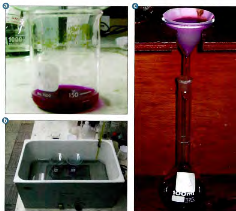
Figura 8.7. Muestra. a. Reposo. b. Calentar al baño María. c. Filtrado.
