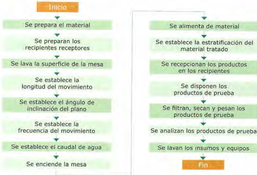
Figura 5.3. Diagrama del proceso de concentración.
