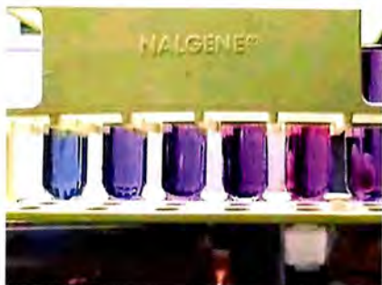
Figura 9.1. Color desarrollado después de 40 minutos, adicionando la solución de cloruro estañoso en la solución áurica acidificada.
