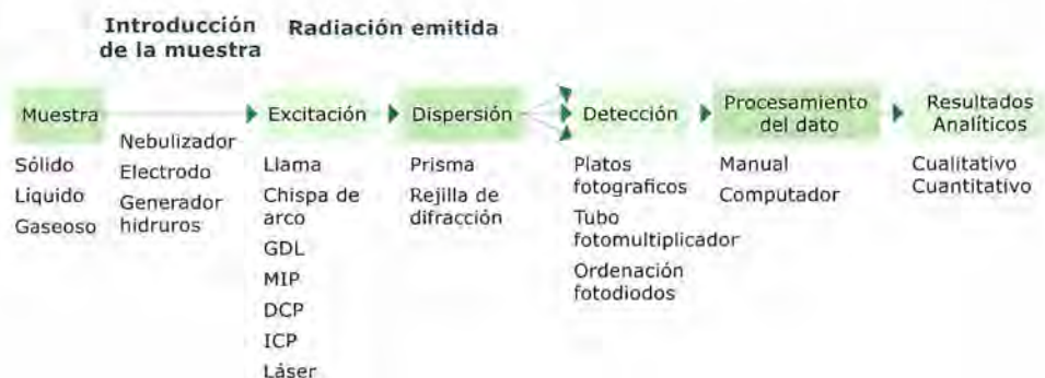
Figura 1.2. Procesos en la obtención de resultados analíticos de una muestra.
