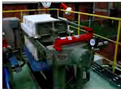
Figura 6.1. Filtro prensa de la planta piloto.
