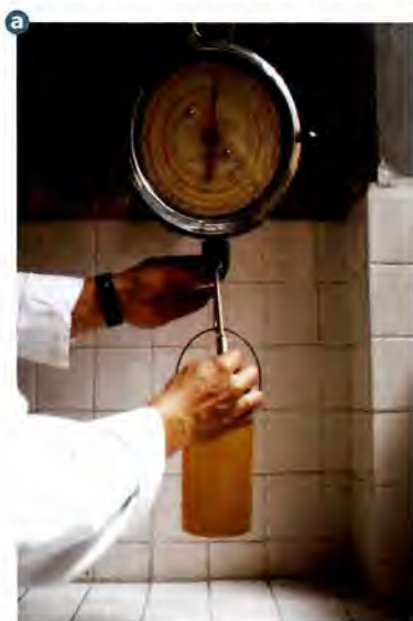
Figura 11.7. a. Calibración de la balanza Marcy.
