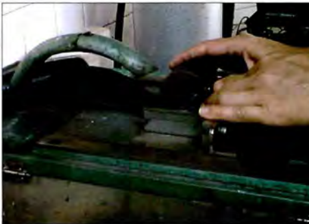
Figura 4.4. Corte de roca hasta 1 mm de espesor.
