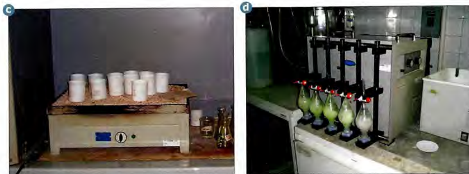
Figura 3.2. c. Plancha de calentamiento, para garantizar un calentamiento homogéneo se coloca una capa de granito en la superficie de la plancha. d. Máquina agitadora Yamato.
