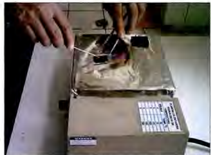
Figura 4.8. Distribución de la muestra sobre la placa.
