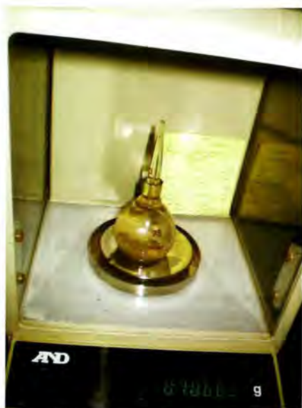
Figura 11.5. Peso del picnómetro lleno.
