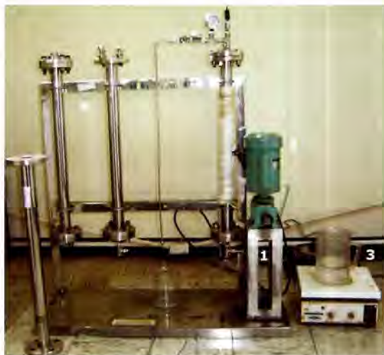
Figura 10.8. Sistema de desorción de oro de carbón activado.
