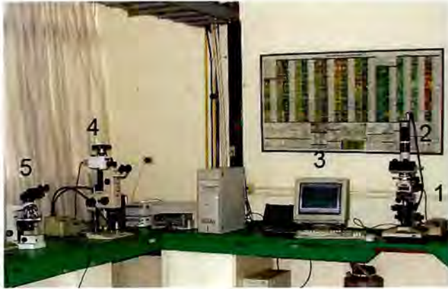
Figura 5.3. Equipos utilizados en el análisis de muestras: microscopio petrográfico Leitz (1), cámara CCD (2), analizador de imágenes Leika Qwin 500 (3), lupa binocular Olympus SZH (4), microscopio calcográfico Olympus BH2 (5).
