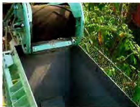
Figura 1.3. a. Tolva de almacenamiento. b. Alimentador vibratorio
