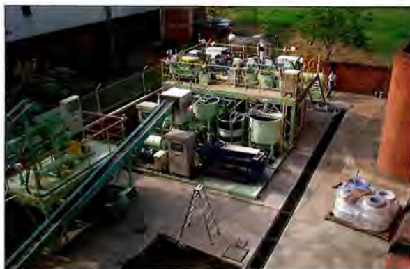
Figura 2.8. Banda alimentadora a tolva del molino.
