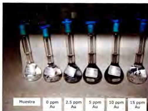
Figura 9.5. Estándares de oro para calibración en el V-Vis. A partir del segundo estándar se tienen las siguientes concentraciones 0,0; 2,5; 5,0; 10,0 y 15,0 ppm.
