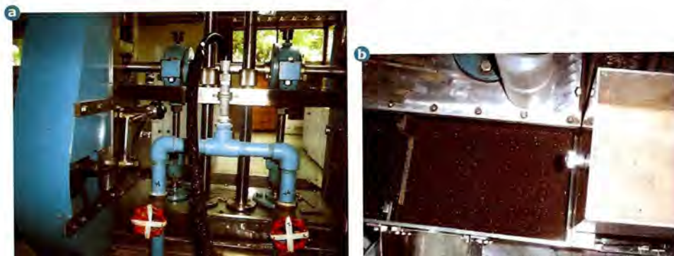
Figura 6.6. a. Válvulas de control de agua. b. Lecho artificial. Tolva de alimentación.
