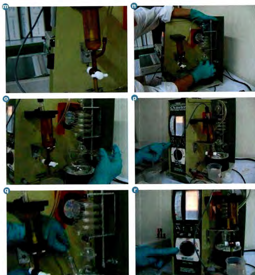
Figura 10.3 . m. Introducción del electrodo en el reservorio. n. Adición de ácido fosfórico. o. Ajuste de matraz de destilación en el manto de destilación. p. Encendido del cianurómetro. q. Ajuste de válvula para regulación de la entrada de aire. r. Ajuste del timer, tiempo de destilación: 60 minutos.
