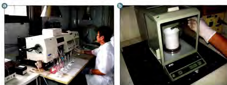
Figura 3.2. a. Espectrofotómetro de absorción atómica, SHIMADZU AA 660 v4. b. Balanza analítica AND para pesaje de muestra problema.
