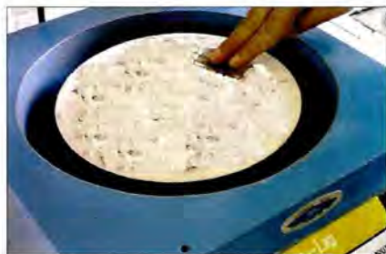
Figura 4.6. Pulido de la sección.
