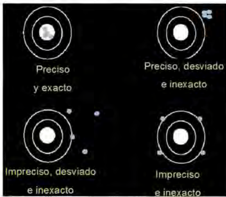
Figura 2.3. Representación gráfica de precisión y exactitud. Fuente: Smith, 2006.
