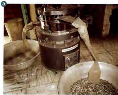
Figura 6.5. a. Tamiz vibratorio. b. Malla.
