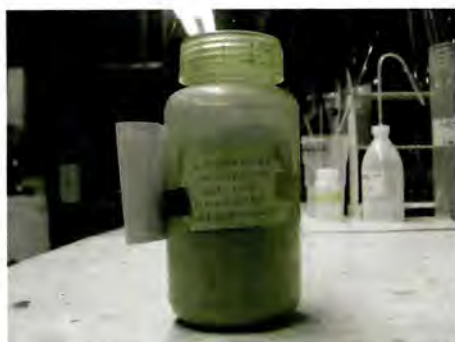
Figura 3.3. Este estándar de referencia sólido contiene oro y plata en concentraciones 15,5 g/T y 9,0 g/T, respectivamente.
