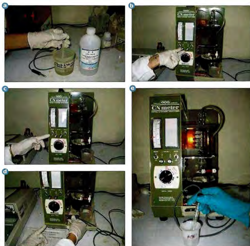
Figura 10.2. a. Reactivación del electrodo de ión selectivo para cianuro. b. Ajuste de los botones de calibración. c. Encendido y apagado del analizador. d. Conexión del electrodo al equipo analizador. e. Calibración del cianurómetro con los diferentes estándares.
