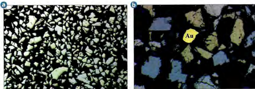
Figura 11. Fotomicrografías de concentrados de sulfuros: a. polimetálicos. b. Partícula de oro en concentrados.
