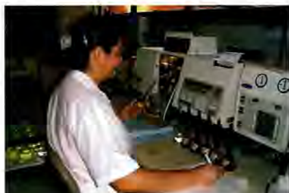
Figura 4.1. Cuantificación en el espectrofotómetro de absorción atómica de soluciones de plata.
