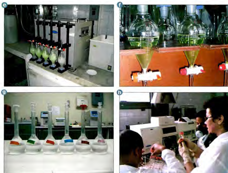
Figura 3.9. a. Muestra en proceso de sequedad. Se observa apariencia gomosa. b. Solución a traspasar al embudo de extracción. c. Recepción solución. d. Adición de MIBK. e. Mezcla en la máquina agitadora. f. Separación de dos fases orgánica-acuosa. g. Estándares de calibración. h. Lectura en absorción atómica.
