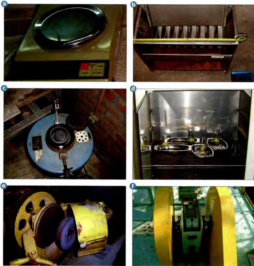
Figura 1.2. Equipos para la preparación de muestras: a. Balanza. b. Cuarteador. c. Molino de anillos. d. Secador con aire caliente. e. Molino de discos. f. Trituradora de quijadas.
