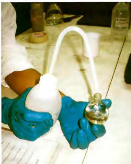
Figura 11.4. Llenado del picnómetro con líquido.
