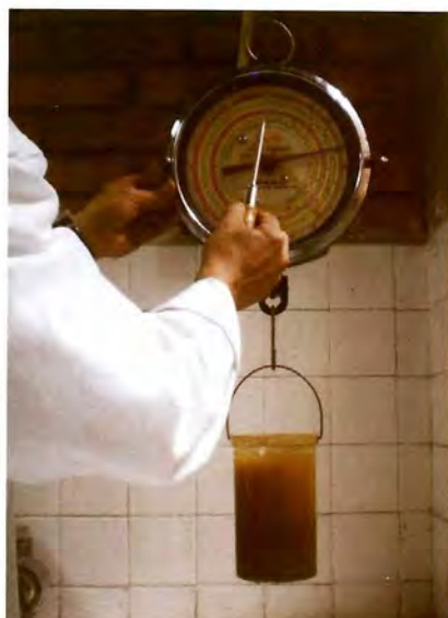
Figura 11.8. Identificación de la densidad de los sólidos.
