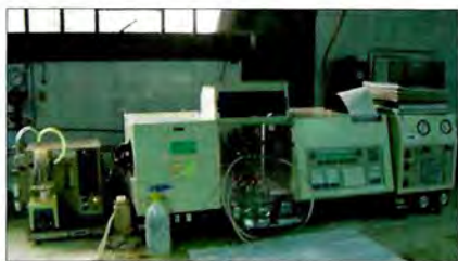
Figura 8.1. Unidad generadora de vapor frío de mercurio acoplada al espectrofotómetro de absorción atómica Shimadzu AA 660 V4.
