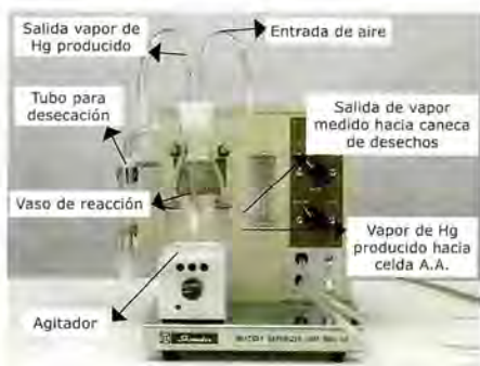
Figura 8.3. Unidad generadora de vapor frío de mercurio.
