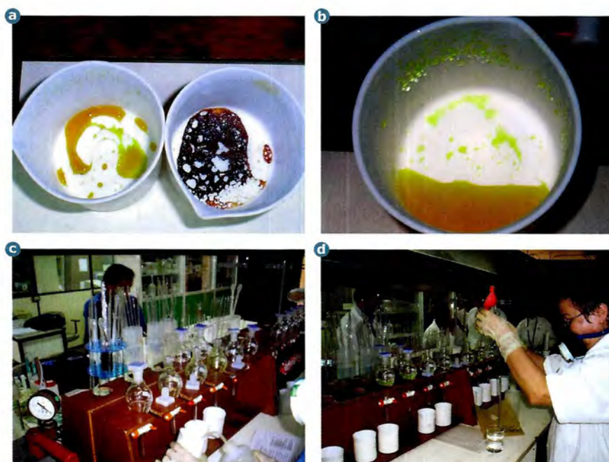
Figura 3.8. a. Recepción de la muestra. b. Pesaje de la muestra. c. Humectación de la muestra. d. Adición de químicos.
