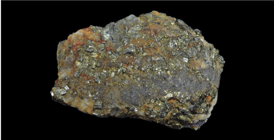
22 Calcopirita (sulfuro de cobre y hierro)
