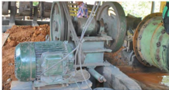
Fotografía 8.5. Trituradora de mandíbulas. Fuente: autores.
