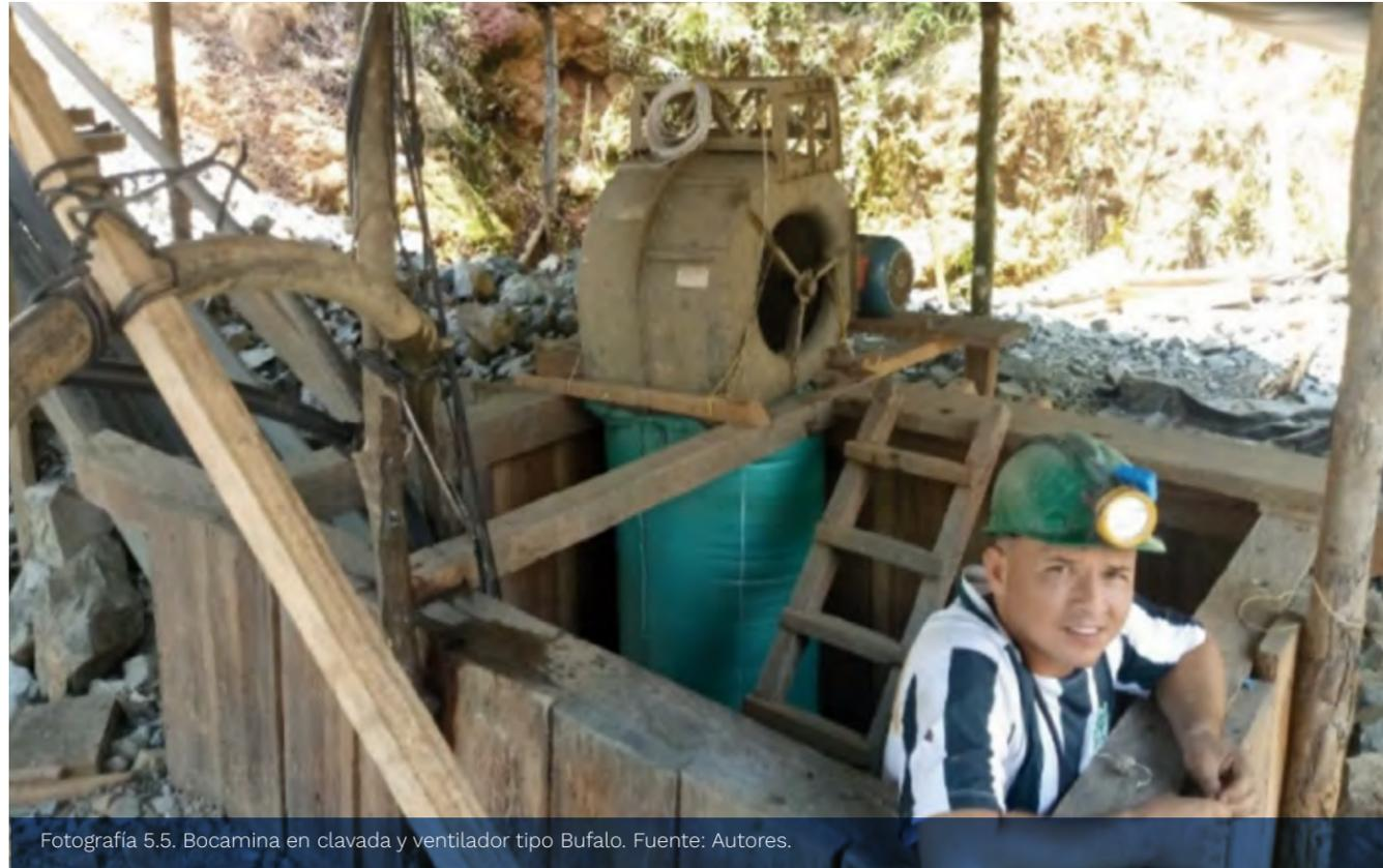
Fotografía 5.5. Bocamina en clavada y ventilador tipo Bufalo. Fuente: Autores.
