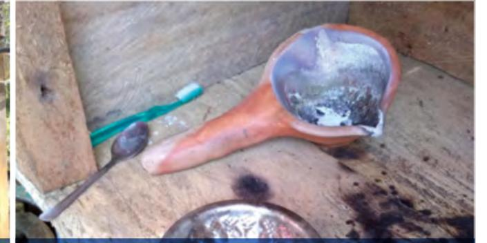
Fotografía 8.4. Cuchara refractaria y concentrado para fundición. Fuente: autores.
