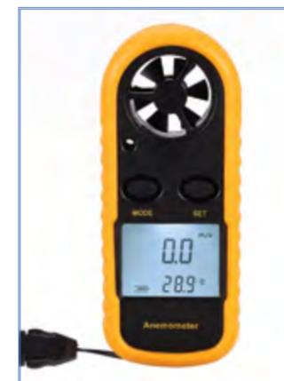
Fotografía 5.13. Termómetro anemómetro. Fuente: <https://mlstaticquic-a.akamaihd.net>.
