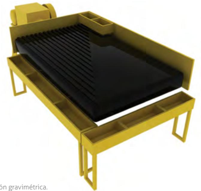
Figura 5.7: Diagrama de funcionamiento de una mesa de concentración gravimétrica. Fuente: Propia.
