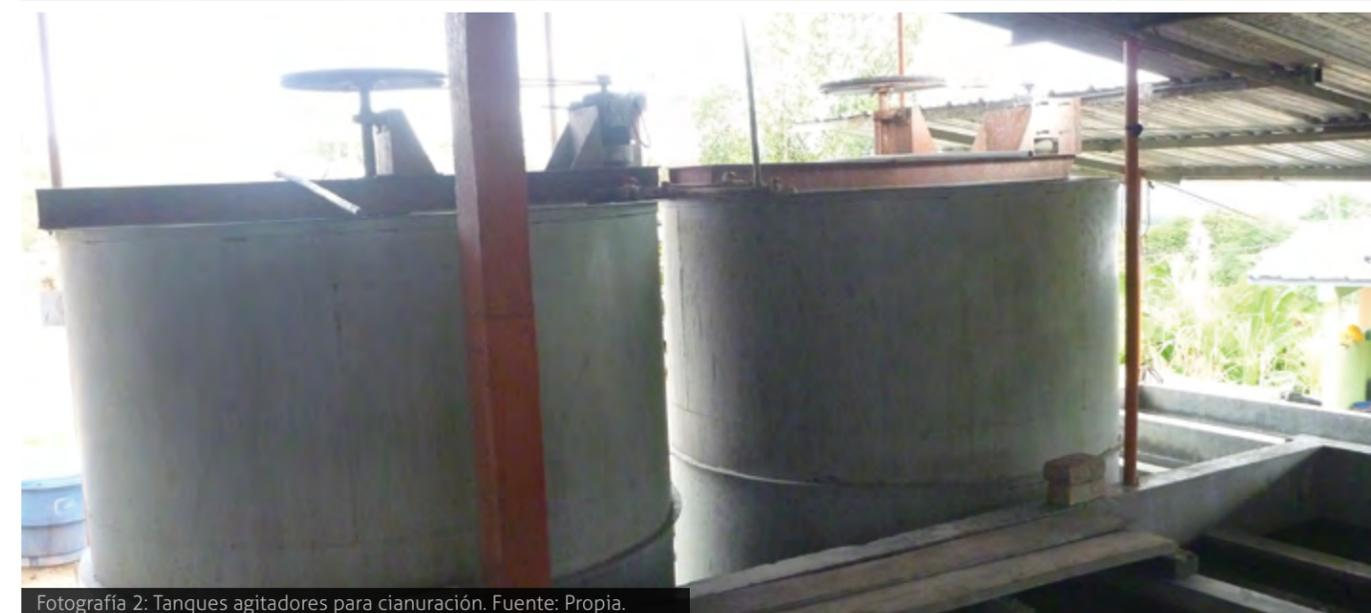
Fotografía 2: Tanques agitadores para cianuración. Fuente: Propia.
