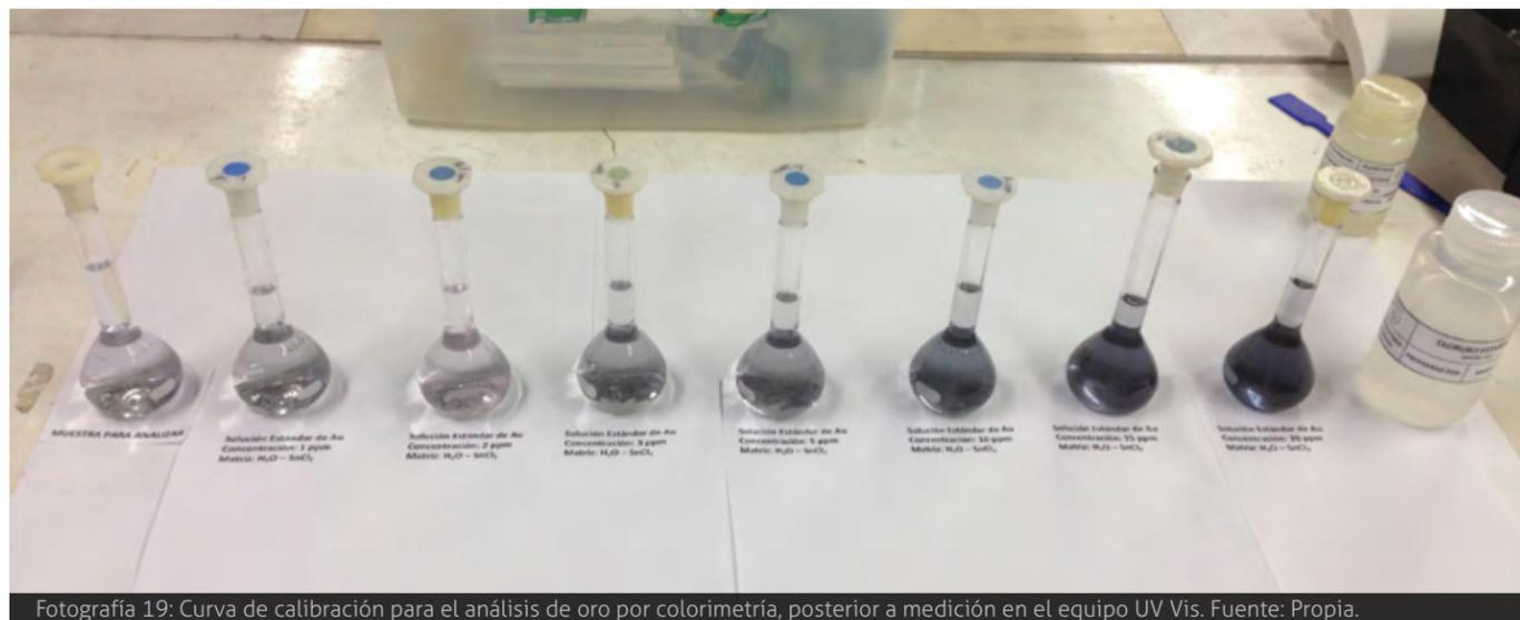
Fotografía 19: Curva de calibración para el análisis de oro por colorimetría, posterior a medición en el equipo UV Vis. Fuente: Propia.
