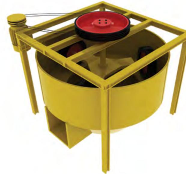
**El molino chileno es una máquina versátil que permite triturar, moler y concentrar el oro grueso. Para el caso de las asociaciones es muy útil, debido a que cada minero puede trabajar su material sin que exista mezcla con materiales de diferentes minas.**
