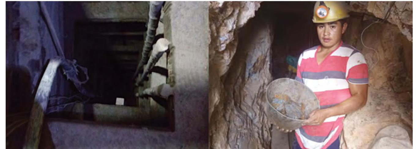
Fotografía 5.3. Sostenimiento artificial y malacate artesanal en el municipio de Almaguer. Fuente: autores.
