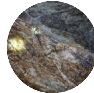
Alteración propilítica pervasiva. La tonalidad verde de la roca caja marcada por la presencia de cloritas, +/- epidota, carbonatos y hematita con alteración filica en vetillas.
