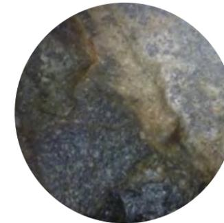
Alteración propilítica pervasiva. Nótese la tonalidad verde de la roca caja marcada por la presencia de cloritas, +/- epidota y carbonatos con alto contenido de sericita asociada a alteración filica en estructuras.
