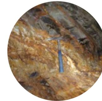
Vetilleo irregular cortando secuencia de rocas sedimentarias levemente propilitizada, Nótese los halos de alteración argílica fuertemente oxidada.
