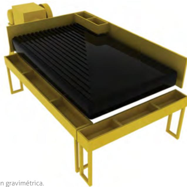
Figura 5.7: Diagrama de funcionamiento de una mesa de concentración gravimétrica. Fuente: Propia.
