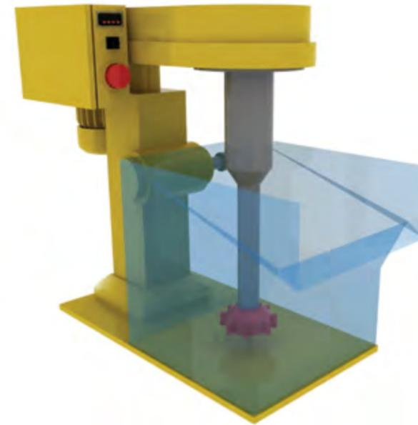
Fotografía 12: Modelo de celda de flotación industrial. Fuente: Propia.
