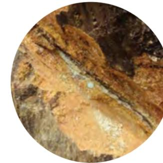
Vetilleo con relleno de óxidos de Fe (Gohetita, hematita, jarosita) con halos de 1 cm de alteración argílica y altos porcentajes de arcillas. Nótese la alteración supérgena de la roca caja.
