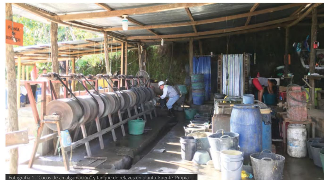
Fotografía 1: "Cocos de amalgamación" y tanque de relaves en planta. Fuente: Propia.
