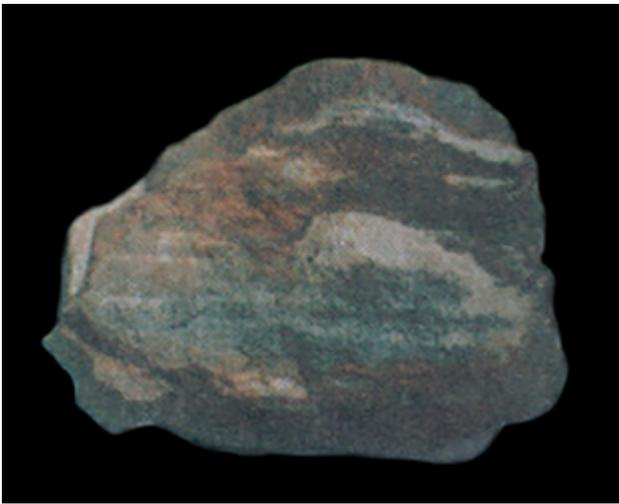
**Figura 20.** Fotografía hierro bandeado. Obsérvese la alternancia de niveles silíceos y niveles ferrosos
