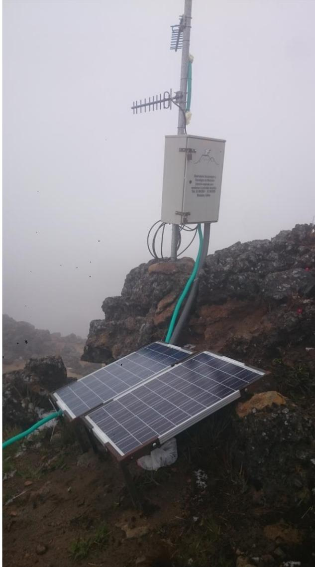
Figura 65. Estación multiparamétrica PARAMILLO.
