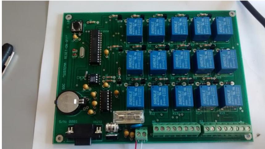
Figura 59. Circuito de Control Automático de Encendido.
