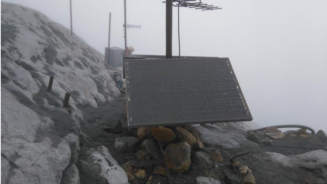
Figura 3. Estación corto periodo BIS con ceniza en sus paneles solares.
