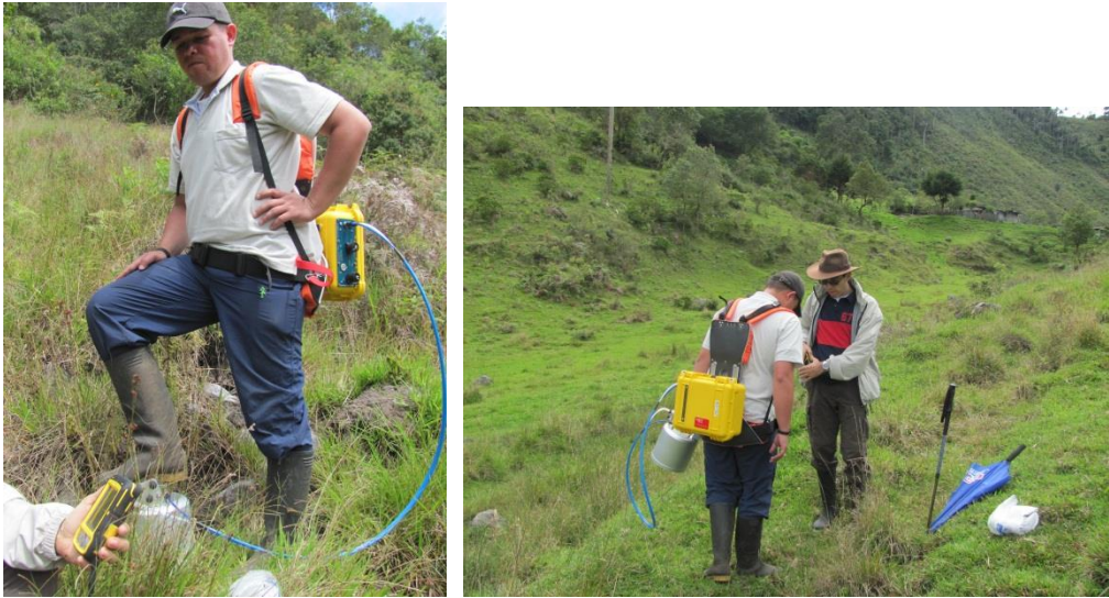
Figura 82. Equipo de Medición LICOR 820 para medida de Flujo de CO 2 en suelo.
