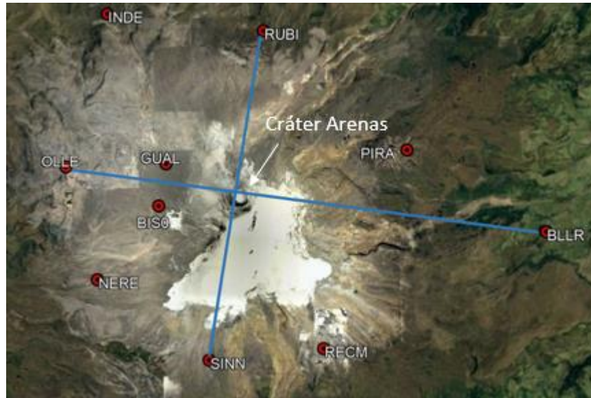
Figura 10. Localización de líneas base GNSS en el Volcán Nevado del Ruiz
