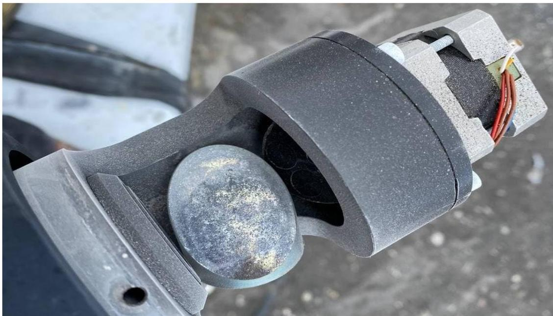
**Figura 3.** Reflector óptico del espectrómetro del ScanDoas de la estación BRUMA. Se observa la pérdida casi total de su película reflectora debido al efecto de gases volcánicos en la zona
