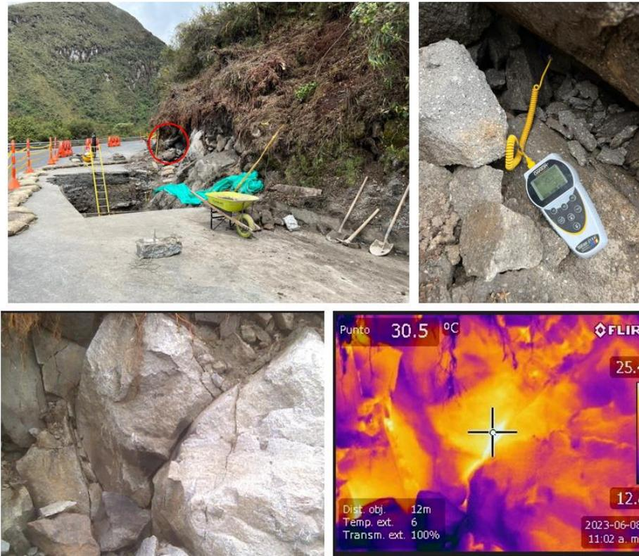
**Figura 41.** Medición de temperatura en el punto principal de anomalía, se aprecian valores máximos 30 °C
