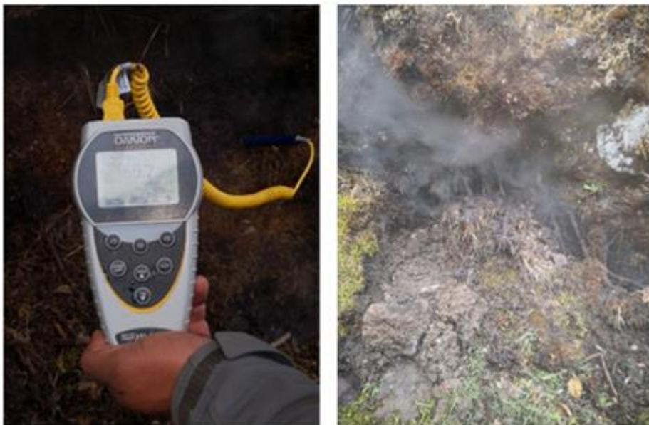
**Figura 11.** Máxima temperatura registrada en la zona de la anomalía (66 °C) correspondiente al punto P1
