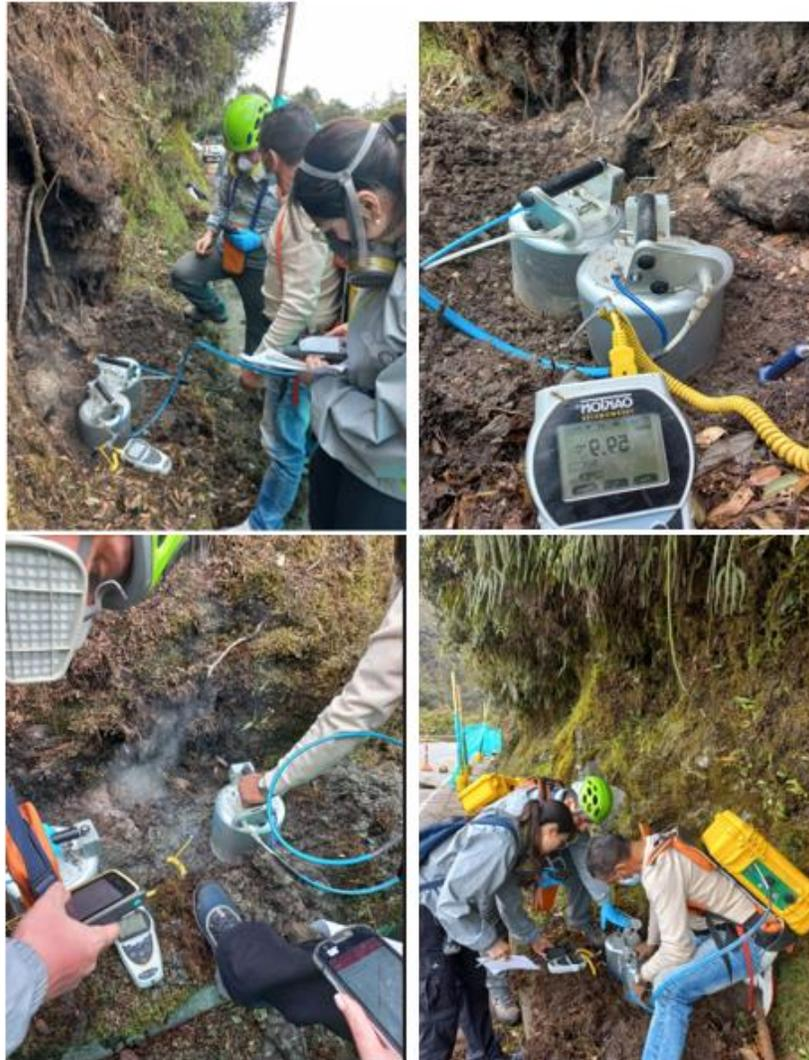
**Figura 32.** Personal del SGC realizando mediciones en zona de anomalía con equipo flujómetro para estimar los flujos de CO<sub>2</sub>, CH<sub>4</sub> y H<sub>2</sub>S
