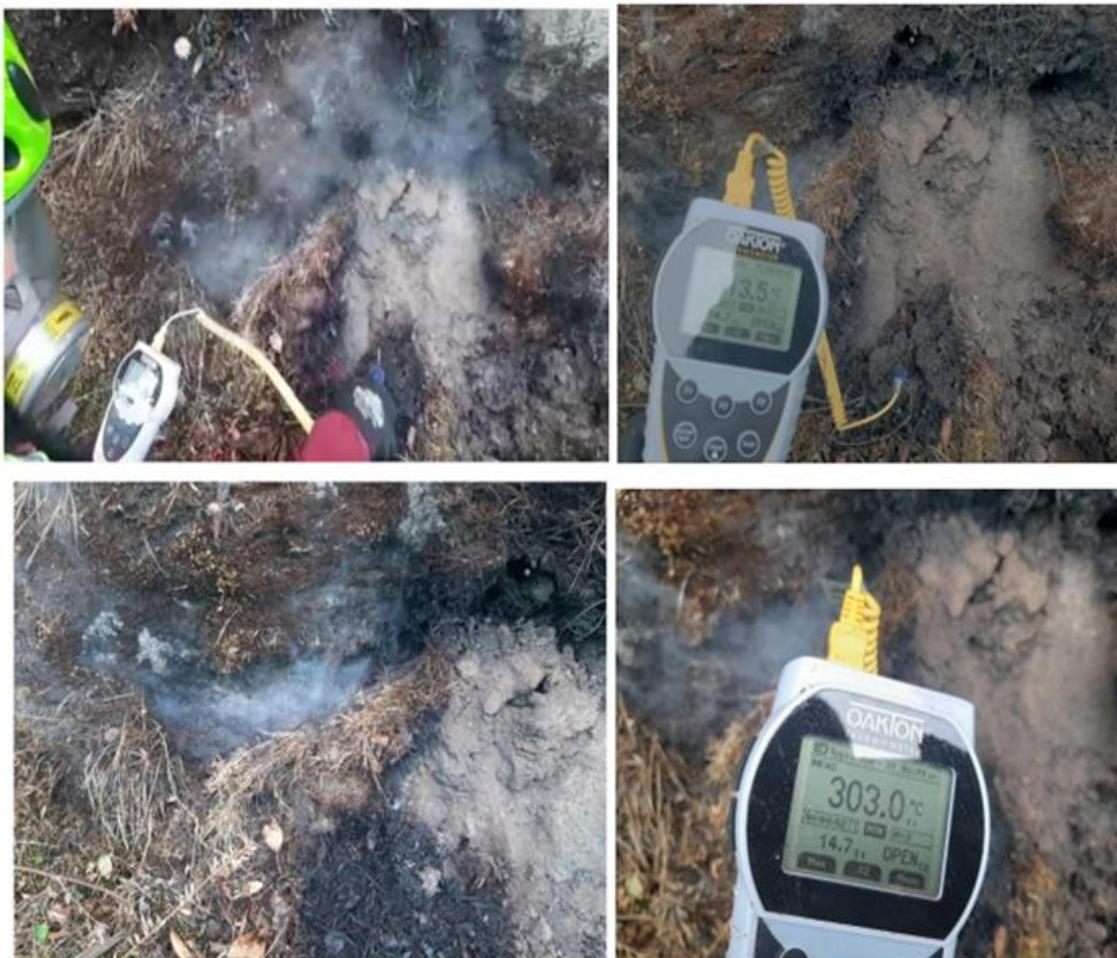
**Figura 23.** Incremento de temperatura en la zona de anomalía registrado el 17 de mayo y cambios registrados en los puntos de emisión que reflejan procesos de combustión
