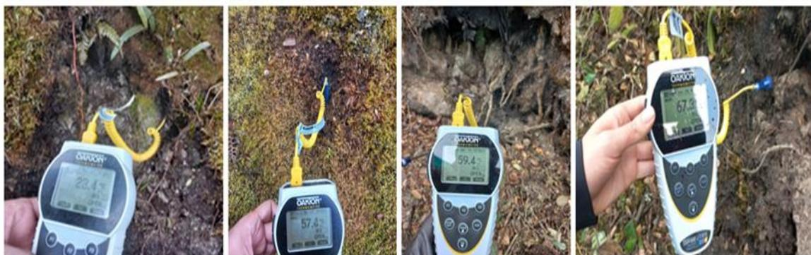
**Figura 20.** Mediciones de temperatura en suelo en algunos de los puntos de salida de gases de la anomalía y evidencia de vegetación seca en los puntos y alrededores próximos
