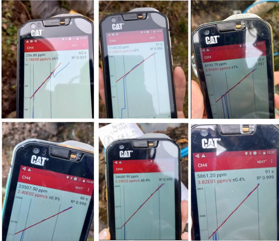
**Figura 33.** Detección de altas concentraciones y flujos de gas metano en zona de anomalía, CVCB. Datos tomados por personal del SGC durante el seguimiento y monitoreo de gases en el sitio
