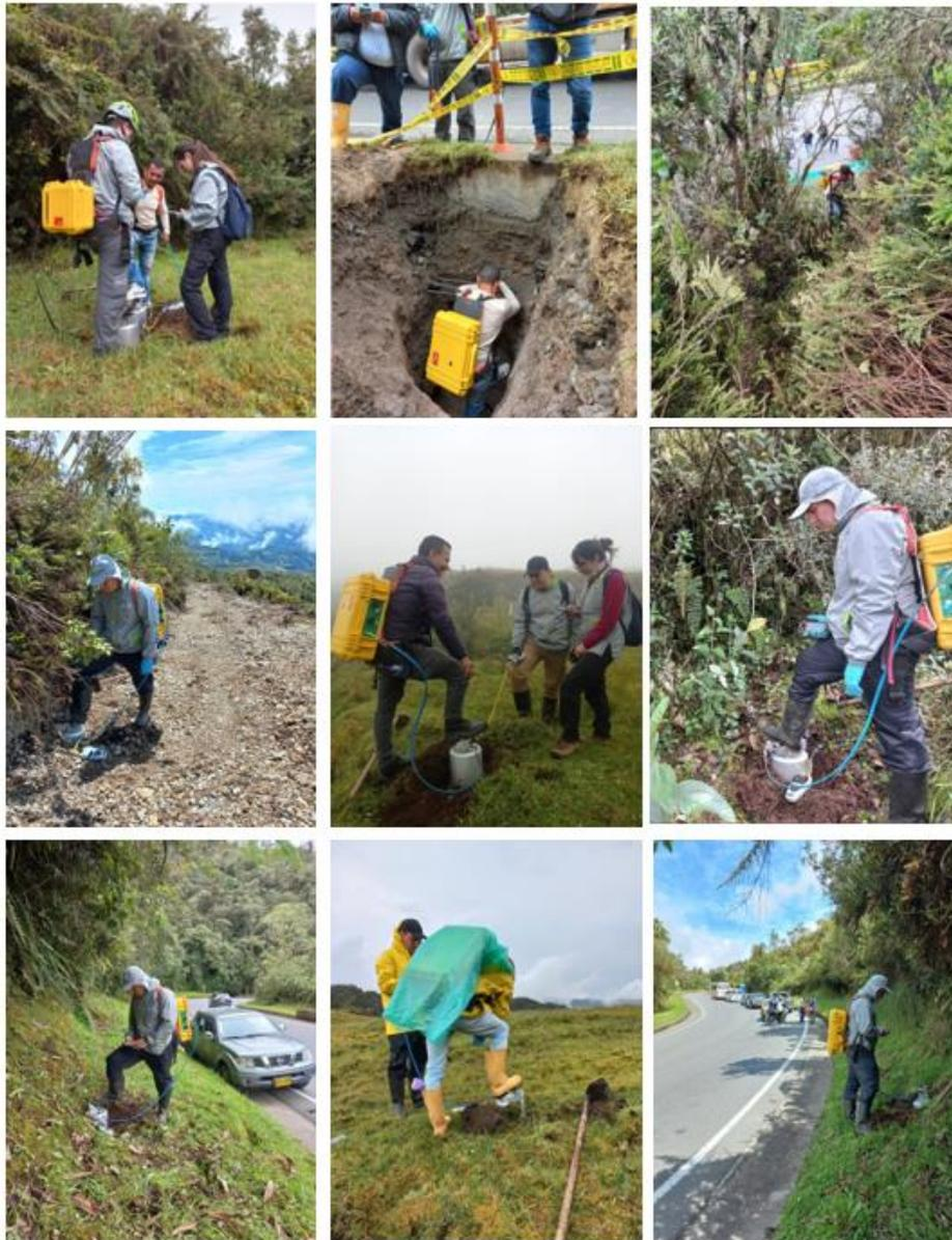
**Figura 31.** Personal del SGC realizando mediciones con equipo flujómetro para determinar presencia de CO<sub>2</sub>, CH<sub>4</sub> y H<sub>2</sub>S en suelo en diferentes flancos del CVCB
