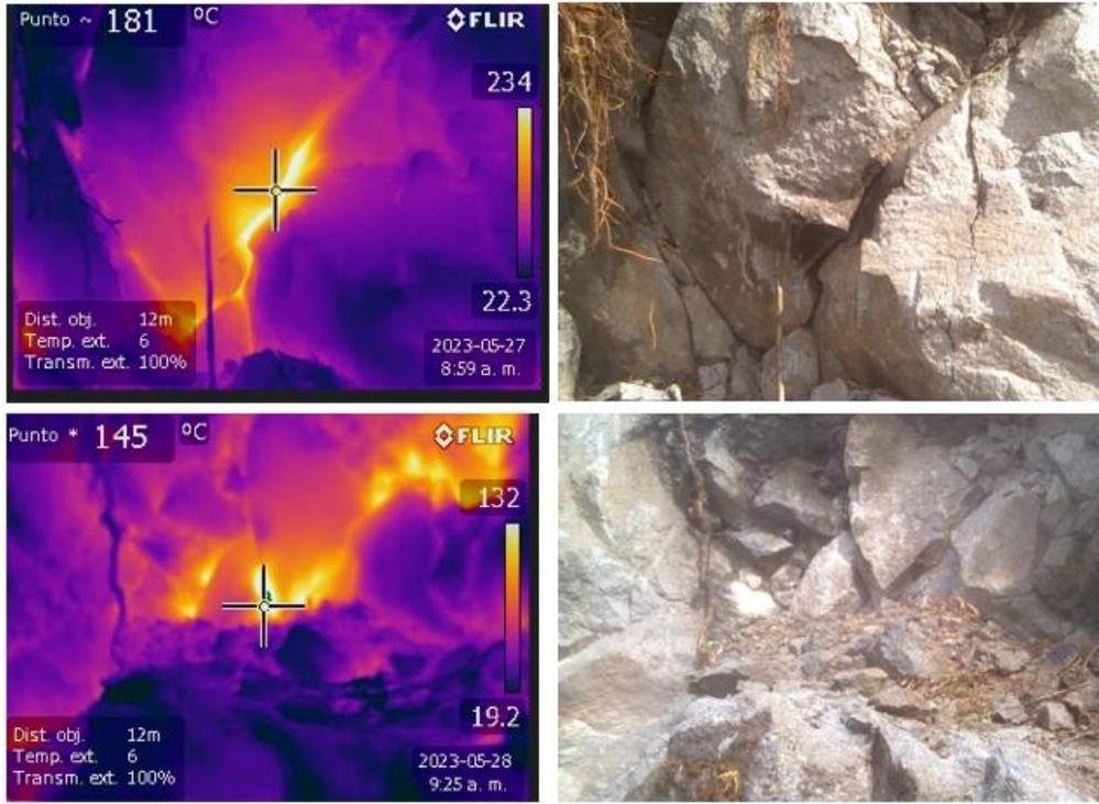
**Figura 30.** Seguimiento de la temperatura en el sector de la anomalía, 27 y 28 de mayo, donde se aprecia la disminución en este parámetro después del uso de agua por parte de la unidad de Bomberos
