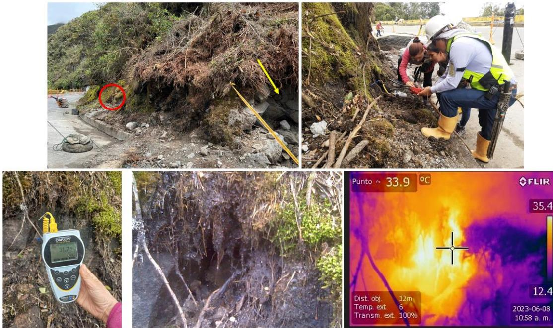
**Figura 40.** Medición de temperatura en el punto ubicado al costado (círculo rojo) del punto principal de anomalía (flecha amarilla), se aprecian valores máximos entre 31 y 35 °C
