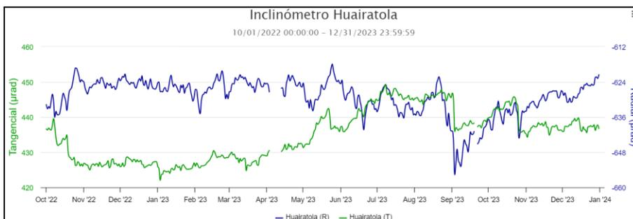
**Figura 10.** Componentes de inclinación Tangencial y Radial ( $\mu\text{rad}$ ) del inclinómetro electrónico Huairatola, instalado en el volcán Galeras, para el periodo comprendido entre el 1 de octubre de 2022 y el 31 de diciembre de 2023
