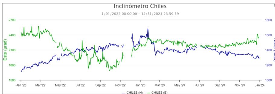
**Figura 68.** Componentes de inclinación Norte y Este ( $\mu\text{rad}$ ) del inclinómetro electrónico Chiles, instalado en el volcán Chiles, para el periodo comprendido entre el 1 de enero de 2022 y el 31 de diciembre de 2023
