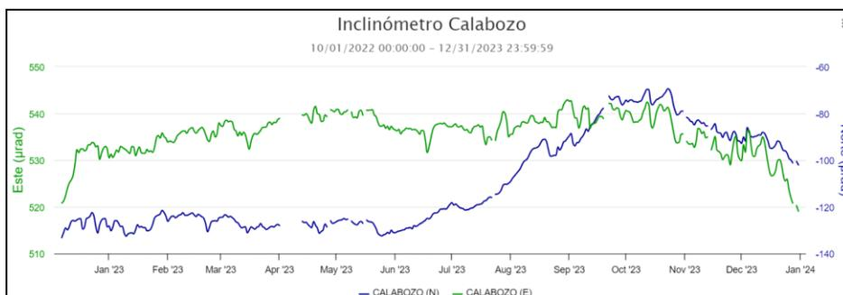
**Figura 11.** Componentes de inclinación Norte y Este ( $\mu\text{rad}$ ) y registro de la temperatura del inclinómetro electrónico Calabozo, instalado en el volcán Galeras, para el periodo comprendido entre el 1 de octubre de 2022 y el 31 de diciembre de 2023
