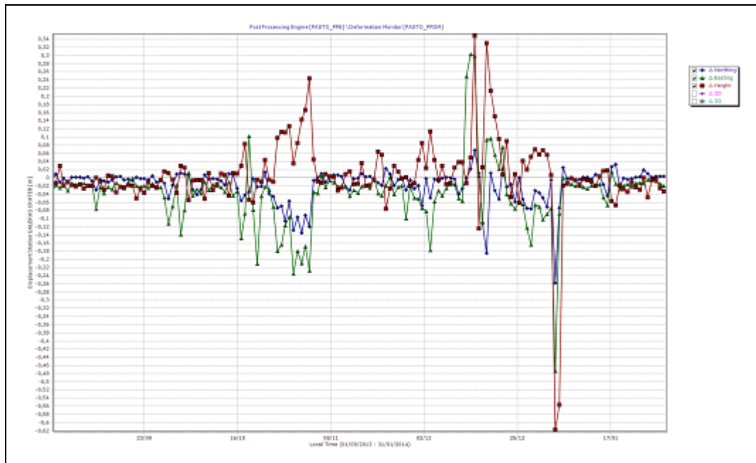
Figura 29. Variaciones en las direcciones Norte, Este y Altura de la estación GNSS Cráter instalada en Galeras, para el periodo comprendido entre el 1 de septiembre de 2013 y el 31 de enero de 2014.
