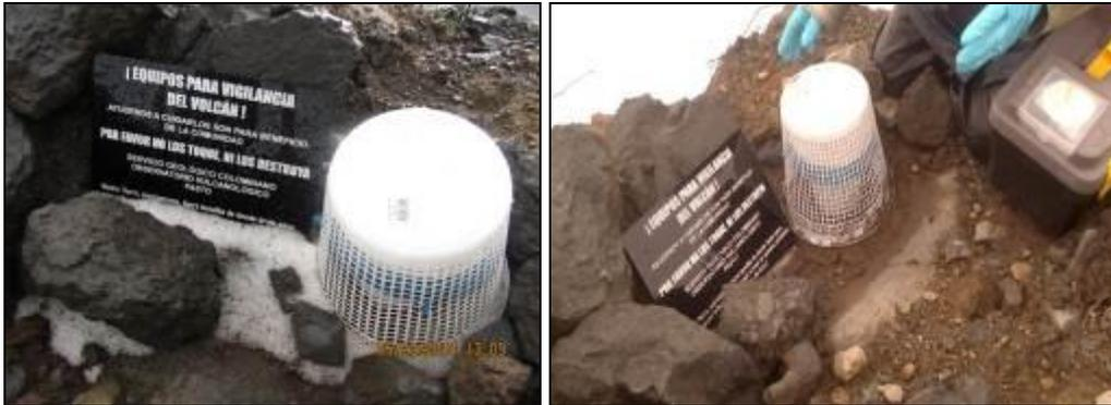
Figura 44. Toma de muestras, estaciones Trampa Alcalina – Cima volcán Galeras.
