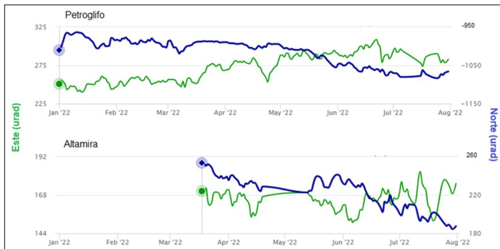
**Figura 76.** Componentes de inclinación Norte y Este ( $\mu\text{rad}$ ) de los inclinómetros electrónicos Petroglifo y Altamira, instalados en el volcán Las Ánimas, para el periodo comprendido entre el 1 de enero de 2022 y el 31 de julio de 2022
