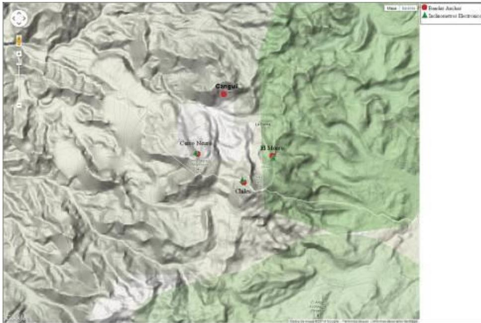
Figura 76. Estaciones sísmicas definidas (círculos rojos) y de deformación (Triángulos verdes) para los volcanes Chiles y Cerro Negro del lado Colombiano.
