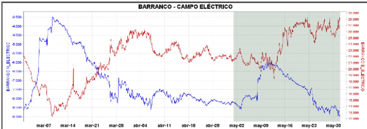
**Figura 33.** Comportamiento del monitoreo continuo de las variaciones SP en la estación de Barranco. La línea azul corresponde a la componente NS y la roja a la componente EW.
