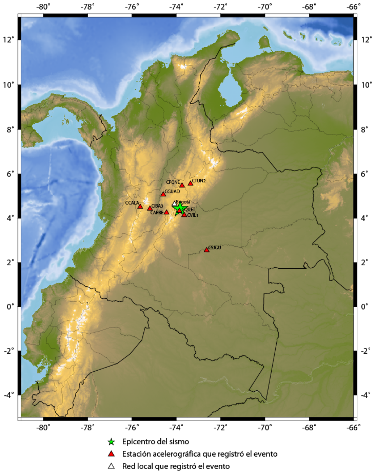
Figura 7. Sismo de Fómeque (Cundinamarca) del 24 de mayo de 2008 (19:23:04 Hora UT). La estrella muestra la ubicación del sismo y los triángulos, las estaciones de acelerógrafos que lo registraron.
