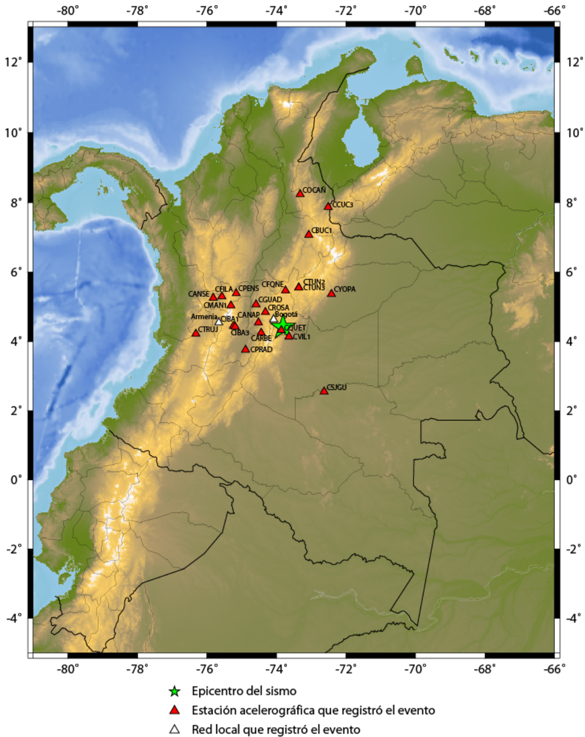
Figura 6. Sismo de Quetame (Cundinamarca) del 24 de mayo de 2008 (19:20:44 Hora UT). La estrella muestra la ubicación del sismo y los triángulos, las estaciones de acelerógrafos que lo registraron.
