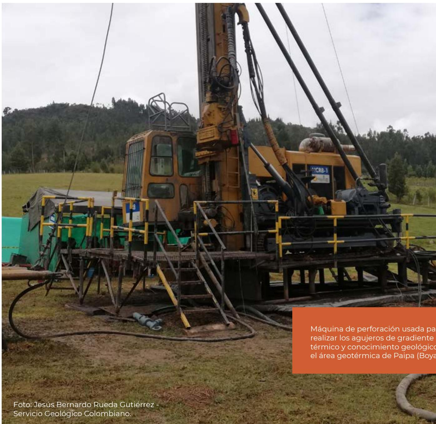
Máquina de perforación usada para realizar los agujeros de gradiente térmico y conocimiento geológico en el área geotérmica de Paipa (Boyacá).
