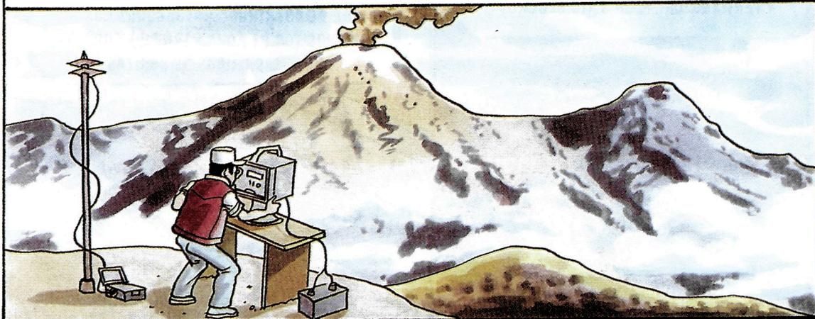
**UN ESPECTÓMETRO DE CORRELACIÓN QUE SE ENGARGA DE LA MEDICIÓN DE LA CONCENTRACIÓN DE DIÓXIDO DE AZUFRE DE ORIGEN FUMARÓLICO EN LA ATMÓSFERA**
