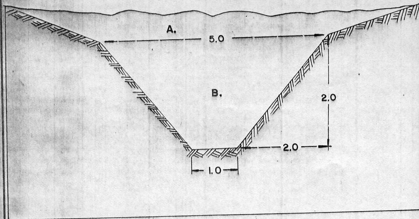
FIGURA 2. SECCION TRANSVERSAL OBRA 4
