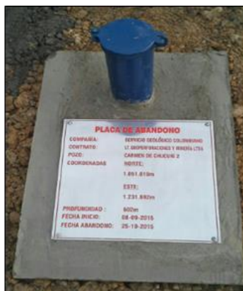
Figura 1. Sellamiento de pozos
