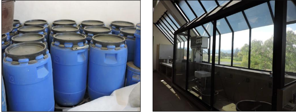
Figura 26. Canecas de ácido sulfánico y cabinas de ácidos con ventanas con películas de seguridad y filtro UV
