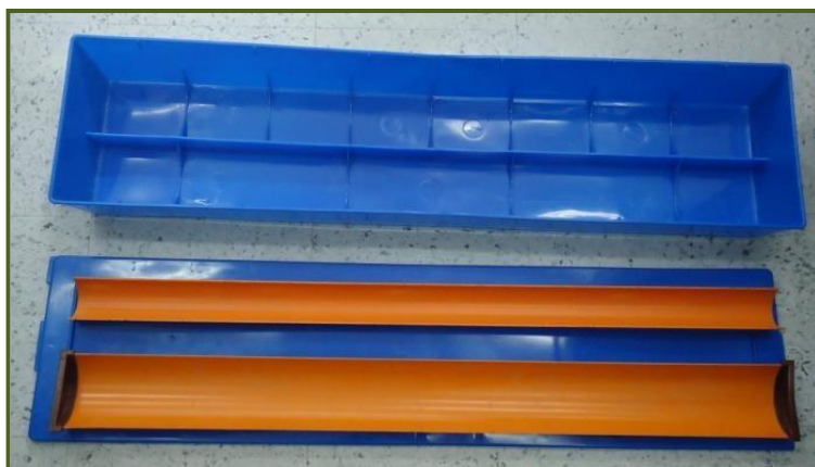
Figura 5. Caja azul estándar de la Litoteca Nacional. (sobre la tapa se aprecian además las canaletas de PVC)
