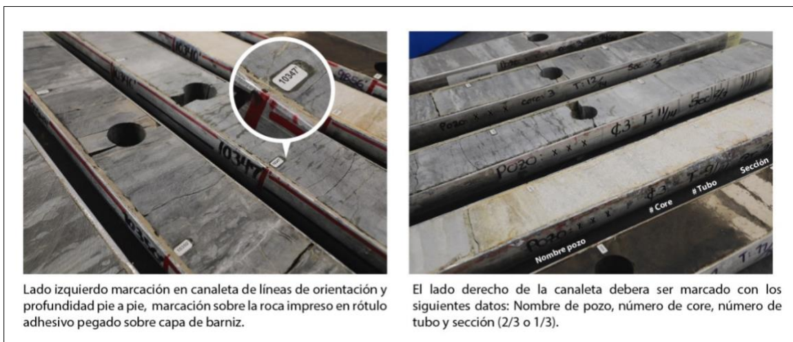
Figura 4. Detalle marcación de corazones y canaletas o mangas de aluminio.
