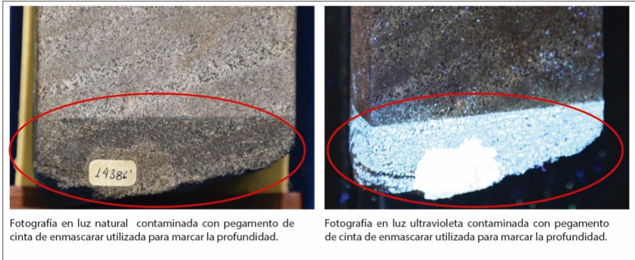
Figura 6. Muestra contaminada con pegamento.
