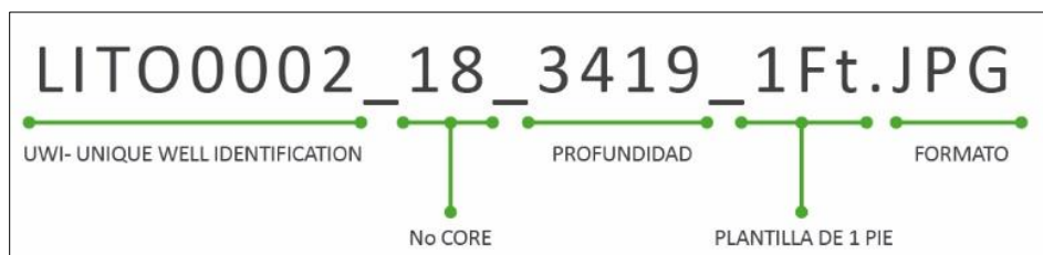
Figura 8. Ejemplo codificación para el nombre de las imágenes en luz natural y ultravioleta.
