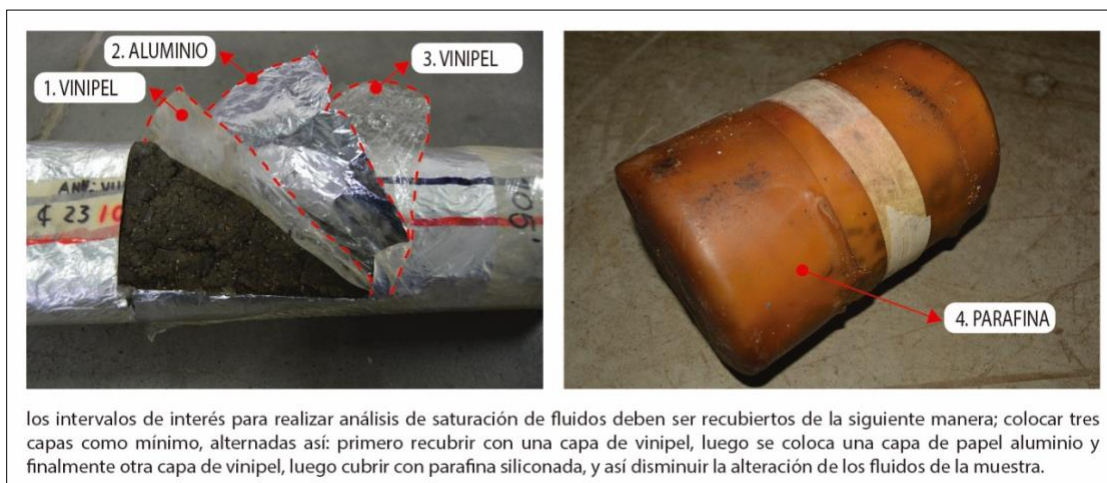
Figura 9. Preservación con vinipel, aluminio y parafina.
